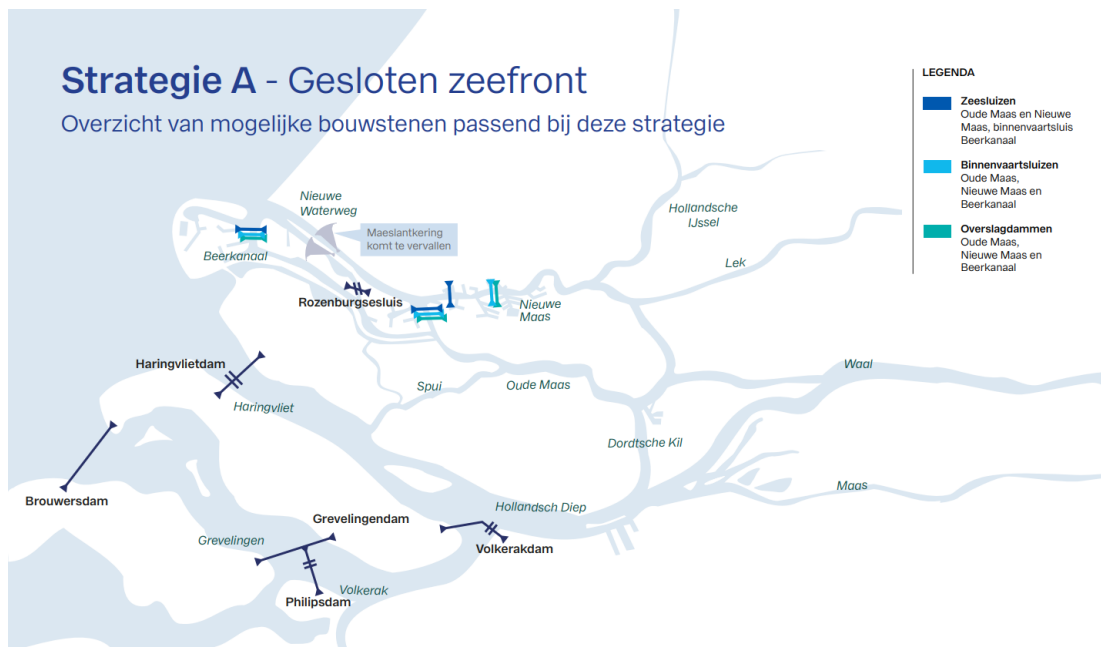
Figuur 4-1 Bouwstenen bij een gesloten zeefront met zeesluizen, binnenvaartsluizen of geheel gesloten dammen.
