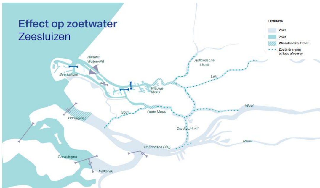
Figuur 4-2 Indicatie van de zoutindringing in het scenario Hd2100 met zeesluizen.
