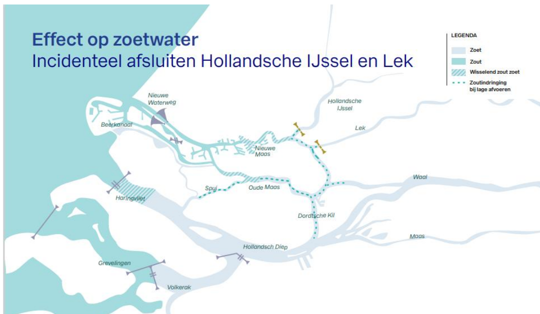
Figuur 3-7 Zoutindringing voor een T=20 lage afvoersituatie in Hd2100 met het incidenteel afsluiten van de Hollandsche IJssel en Lek.
