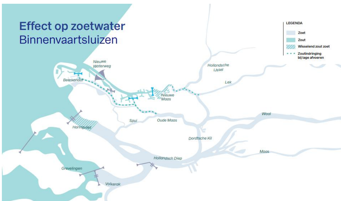
Figuur 4-3 Indicatie van de zoutindringing in het scenario Hd2100 met binnenvaartsluizen.
