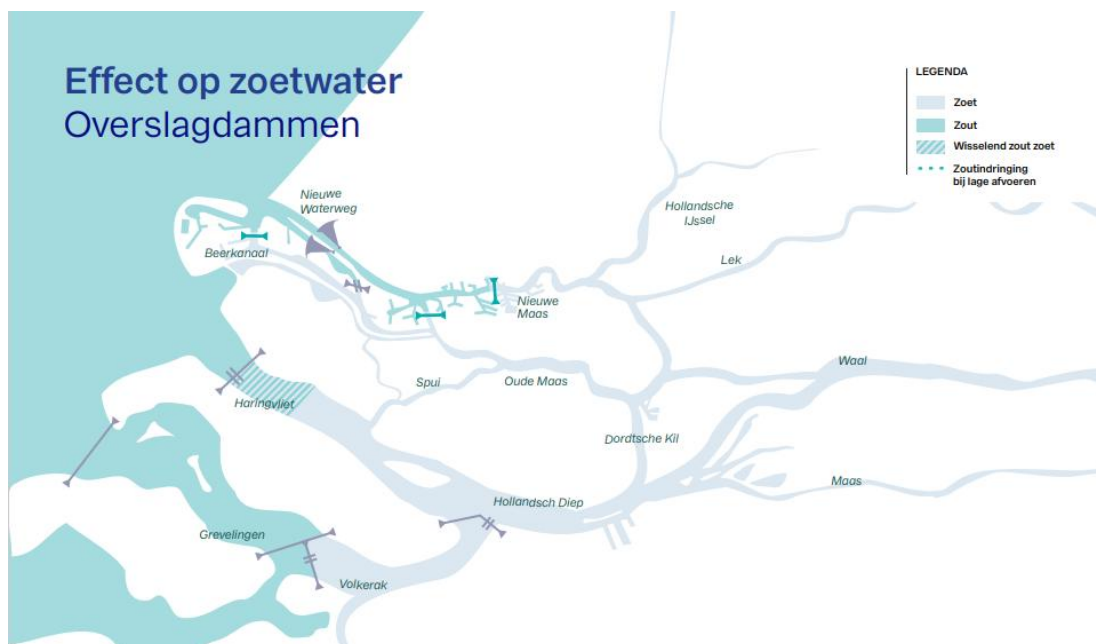
Figuur 4-4 Indicatie van de zoutindringing in het scenario Hd2100 met overslagdammen.
