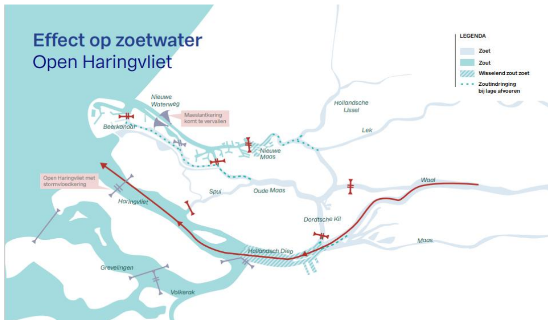
Figuur 4-10 Indicatie van de zoutindringing in het scenario Hd2100 met afgesloten binnenpolder i.c.m. open Haringvliet.
