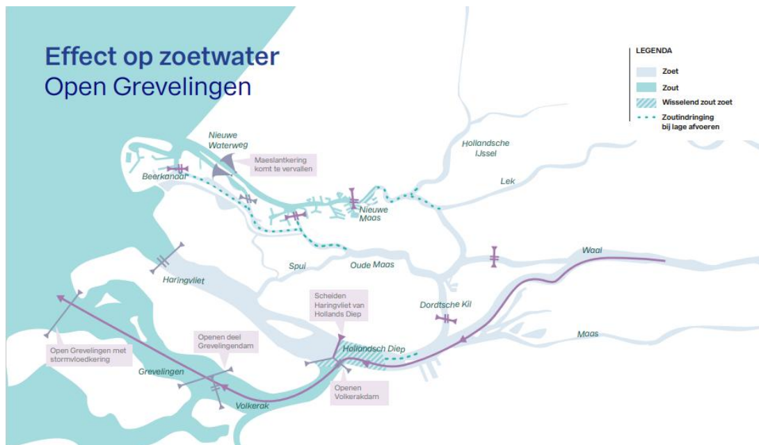
Figuur 4-13 Zoutindringing voor een T=20 lage afvoersituatie in Hd2100 met afgesloten binnenpolder i.c.m. open Grevelingen.
