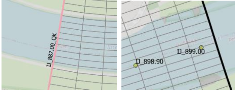
Figuur 22 Afvoerraai op de bovenrand (links) en waterstandspunt bij de benedenrand (rechts) van het verfijnde model (bron: Becker (2024), het rooster was toen nog het 40m-rooster).
