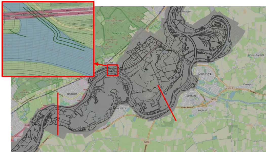
Figuur 8 Modelgebied en interessegebied (rood vak) voor de haveningang van De Steeg. De rode lijnen geven mogelijke locaties van de modelranden aan.
