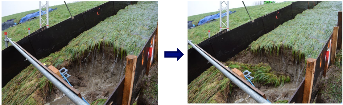
Figuur bijlage A.20 Erosie van de kleibekleding (en gelijktijdig van de zandkern eronder) in een vergevorderd stadium (foto's van een proef in de Hedwige-Prosperpolders).
