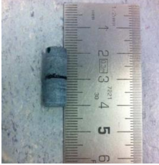
Figuur 2.7 Proefstuk voor de adhesive strength test (AST).
