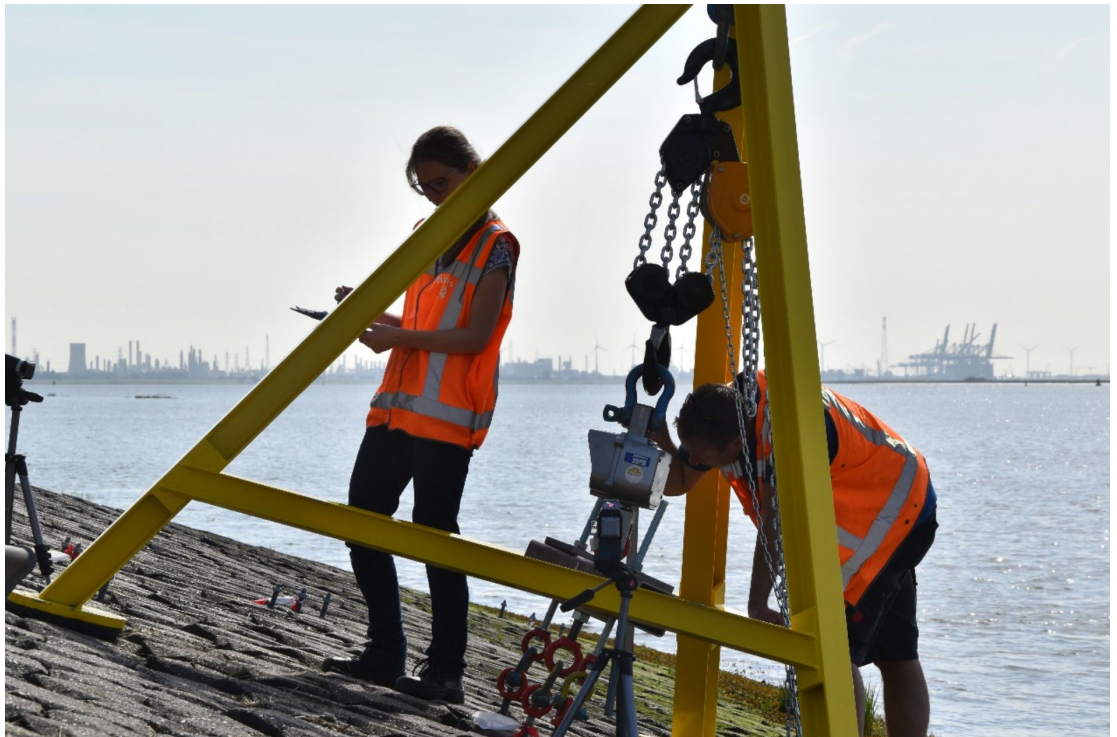
Figuur 3-9, Driepoot met takel, unster, evenaar en hijsogen aan de zetstenen.
