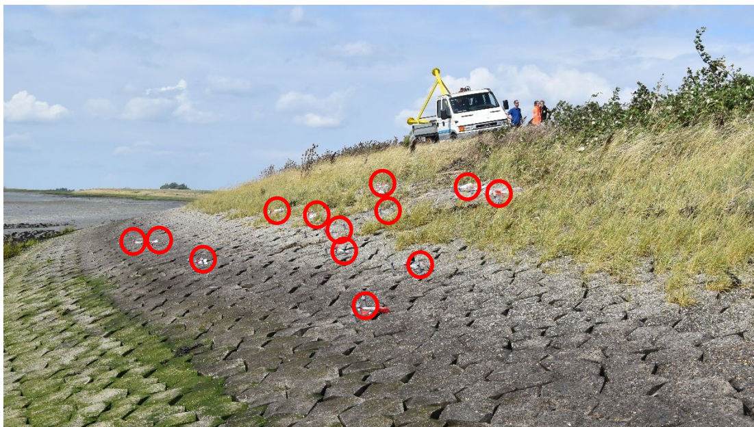
Figuur 3-3, Proeflocaties werden zo dicht mogelijk bij elkaar gekozen, maar met ten minste 3, en waar mogelijk 5 zetstenen tussenruimte om onderlinge beïnvloeding te voorkomen.
