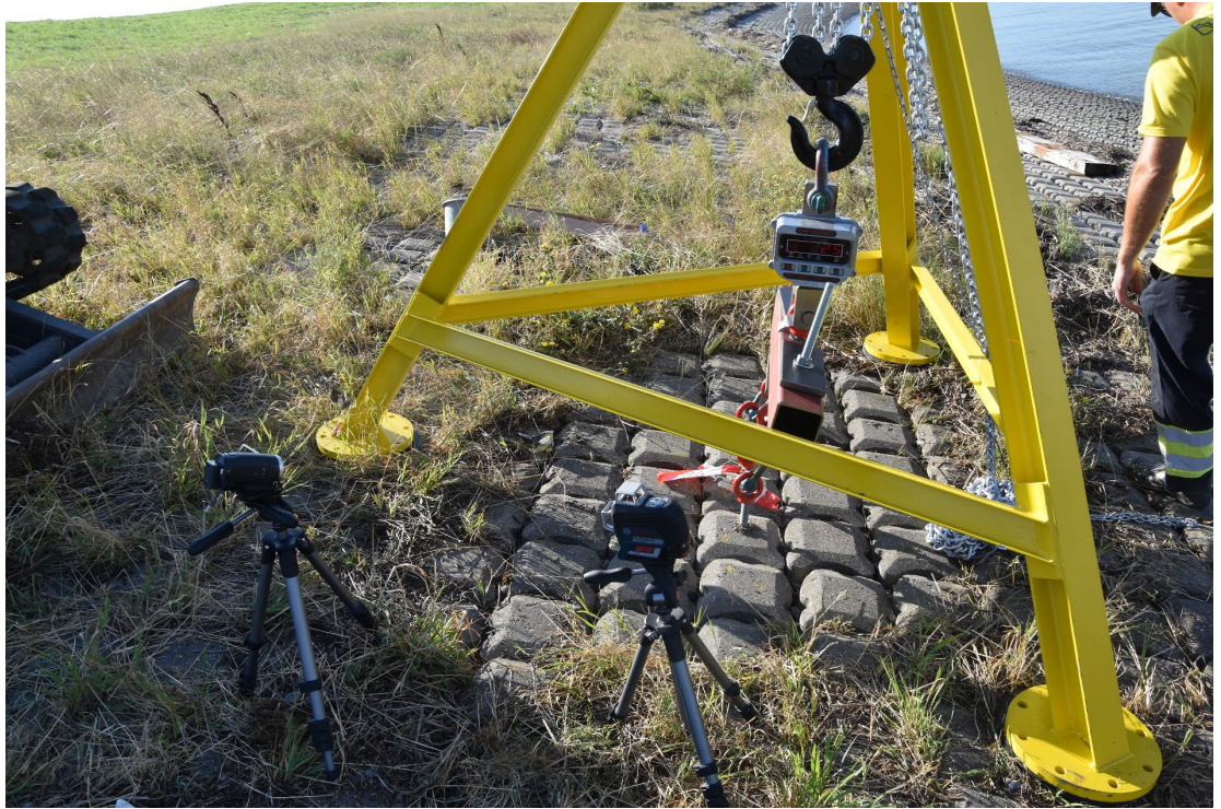
Fig. D-7, Proefopstelling, bevestigd aan de zetstenen. Ook in beeld zijn de camera die op de unster gericht werd en kruislijnlasers die gebruikt werd voor de hoogtemetingen.
