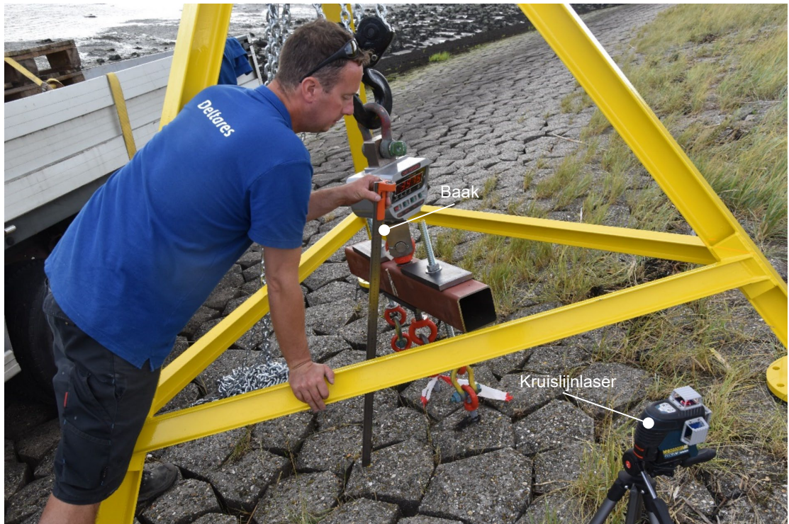
Figuur 3-11, Verplaatsing van de zetstenen is per stap gemeten met een kruislijnlaser die op een baak werd gericht.
