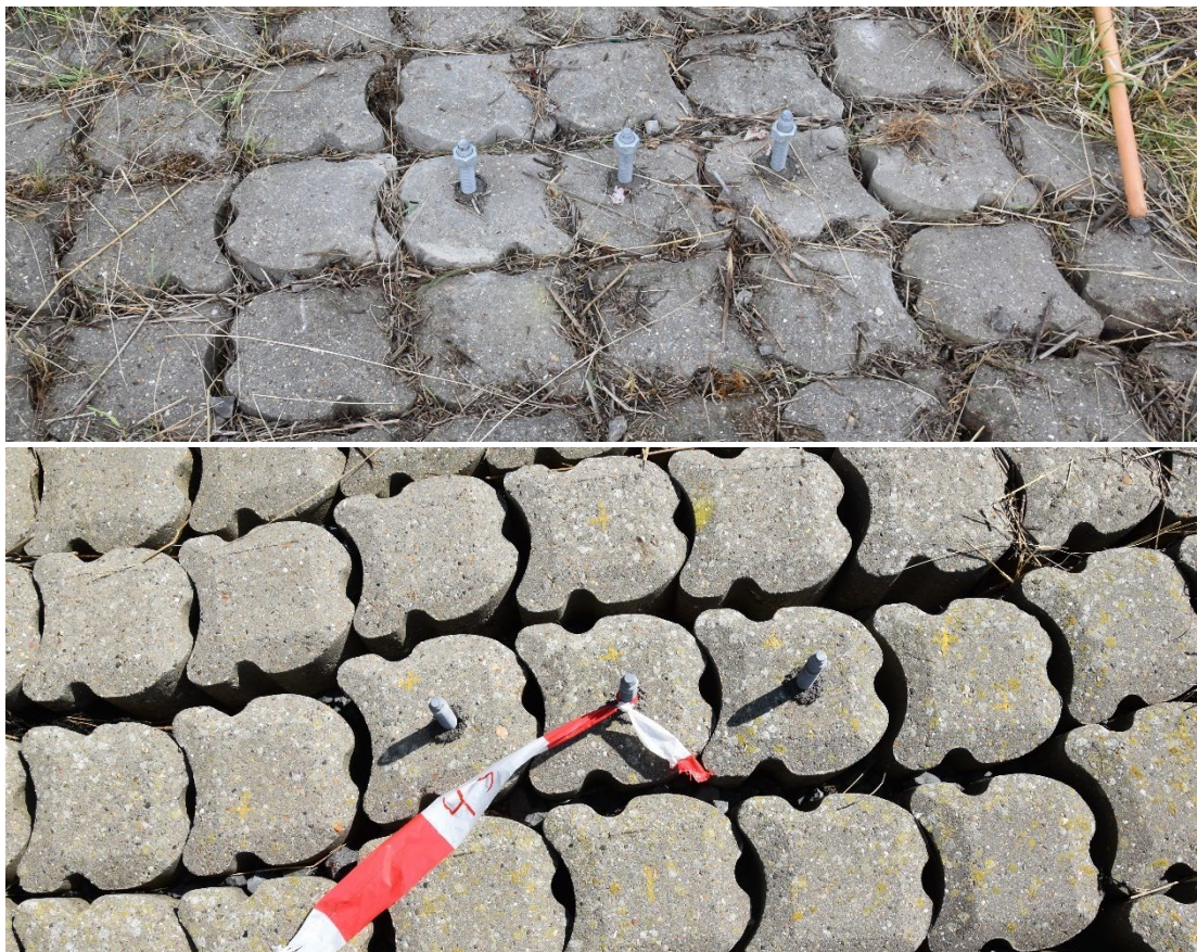
Figuur 3-6, Voorbeelden van een goede (boven) en matige (onder) proeflocatie voor Hydroblocks.
