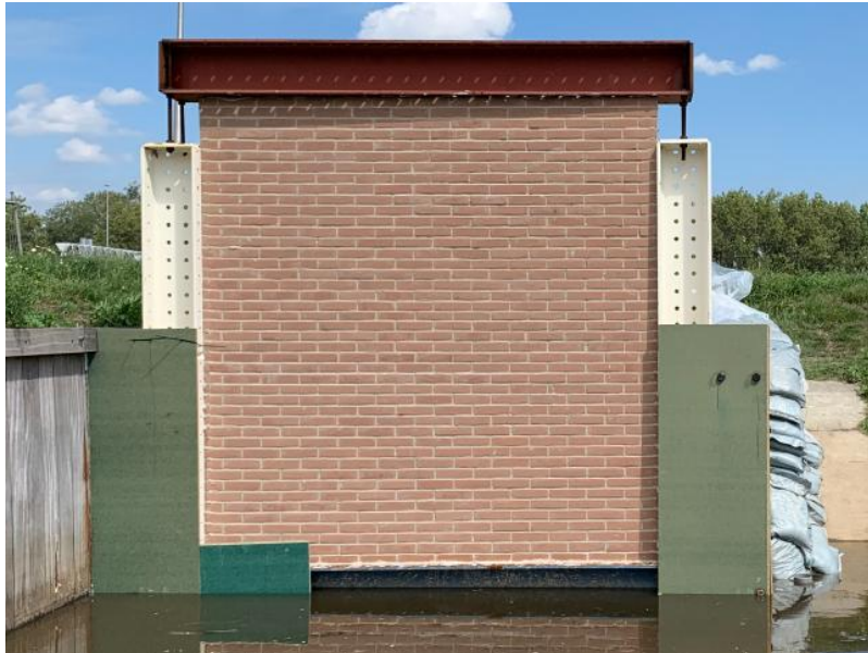
Figuur bijlage A-5. Experimentele setup van weerstand van gemetselde muur tegen water in Flood Proof Holland, Delft (Korswagen, 2021, figure 1).
