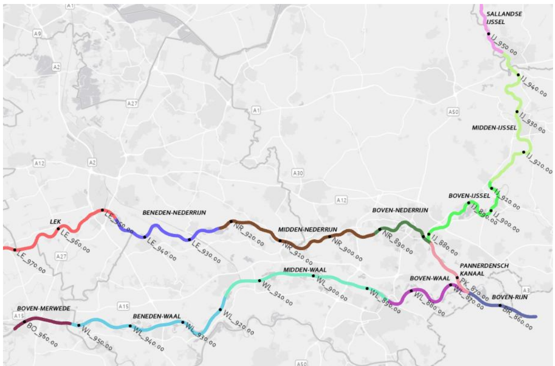
Figuur 2-1 Rivierindeling Rijntakken met de naamgeving als gebruikt in deze studie o.b.v. de IRM-indeling. Ter referentie zijn om de 10 kilometer de rivierkilometerpunten weergegeven.
