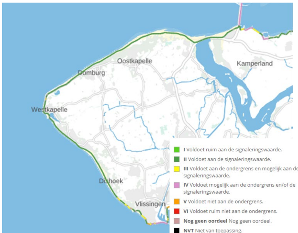
Figuur 4-4. Actuele veiligheidsstatus (toetsoordeel op vakniveau) van de primaire keringen ingezoomd op normtraject 29-1 en 29-2 ( www.waterveiligheidsportaal.nl , geraadpleegd februari 2024).
