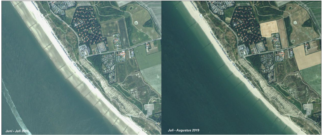
Figuur 7-4. Satellietopname bij Dishoek representatief voor laagwater (links) en hoogwater (rechts). Tijdens laagwater zijn de strekdammen duidelijk zichtbaar. Tussen deze dammen bevindt zich een intergetijdstrand dat aan de zeezijde abrupt over gaat in de voorliggende geulen. Tijdens hoogwater blijft er slechts een smalle droge strandzone over. Bron: Quataert & Elias (2022).
