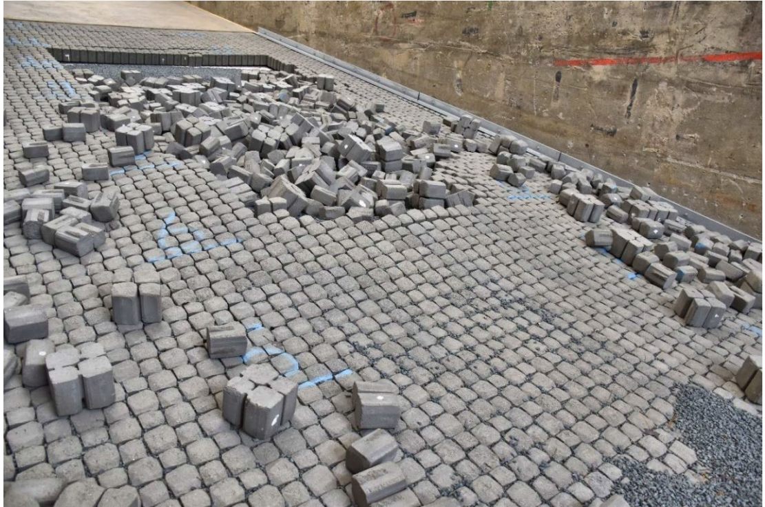
Figuur 2-1, Bezweken steenzetting in de Deltagoot, schadecategorie d. Deltares (2022a)
