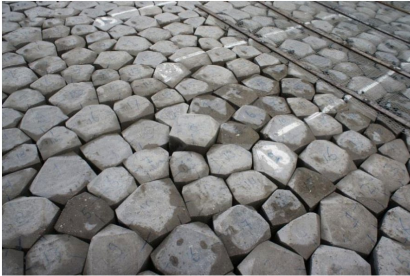
Figuur 2-3, Voorbeeld van oplichten van één enkele zetsteen voor golfaanval (Deltares, 2016a).
