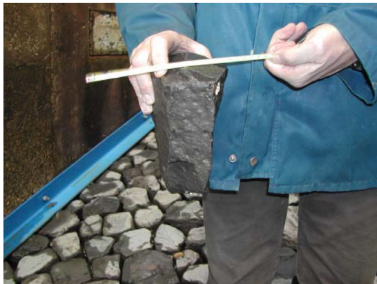
Fig. C-3, Voorbeeld van slechte basaltzuil
