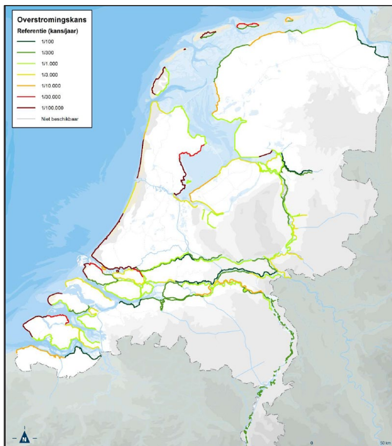
Figuur 2.2 Referentiekansen gebruikt in DPV. In de waterveiligheidsmonitor zijn deze ook gebruikt en zijn daar nog kansen voor de voormalige c-keringen (bijvoorbeeld langs de Hollandse IJssel, zie Bijlage A). Bron: DPV (2016).
