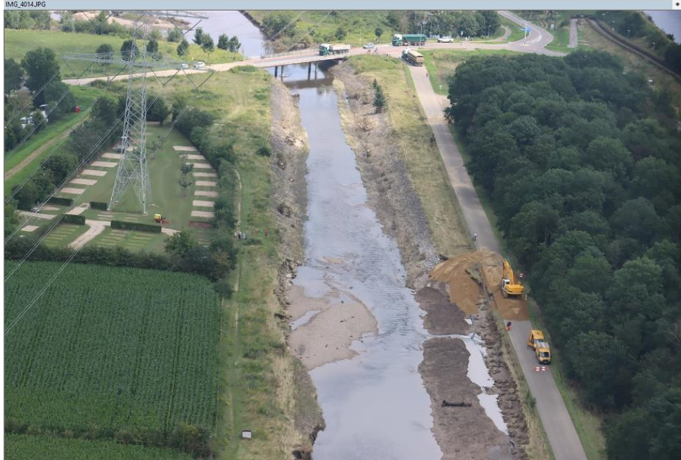
Figuur 3.9 Oevererosie langs de Oude Maas zichtbaar na het hoogwater van juli 2021 (foto: Waterschap Limburg)
