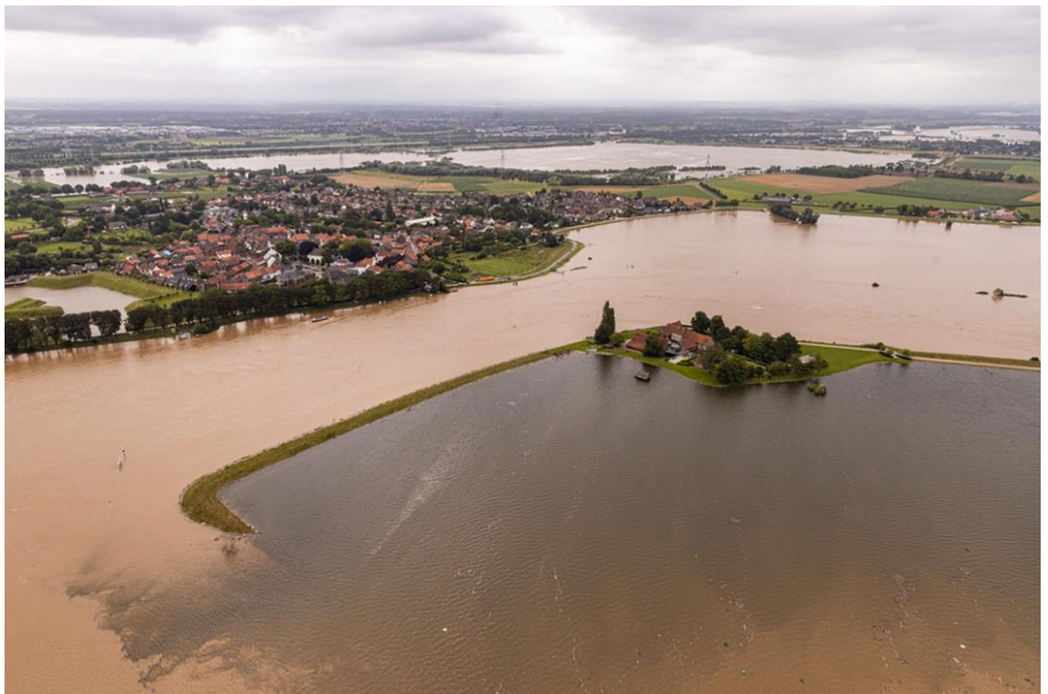
Figuur 9.1 Flessenhals bij Stevensweert. Op de voorgrond de Vissenakkerplas die van de Maas gescheiden is door de Maasdijk (foto: Waterschap Limburg).
