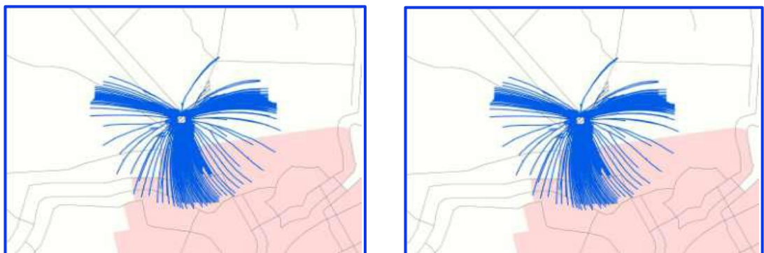
Figuur 2-6 Illustratie van het optreden van “cluttering” van stroombanen bij terugwaartse tracking (links) en het verhelpen van dit probleem middels voorwaartse tracking (rechts). Bron figuur: Provincie Utrecht (2011).
