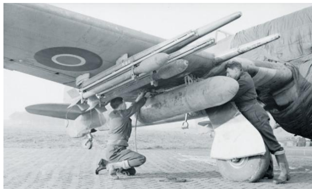
Figuur 6-4. Raketten worden onder een vliegtuigvleugel bevestigd. Uit BeoBom (2014).
