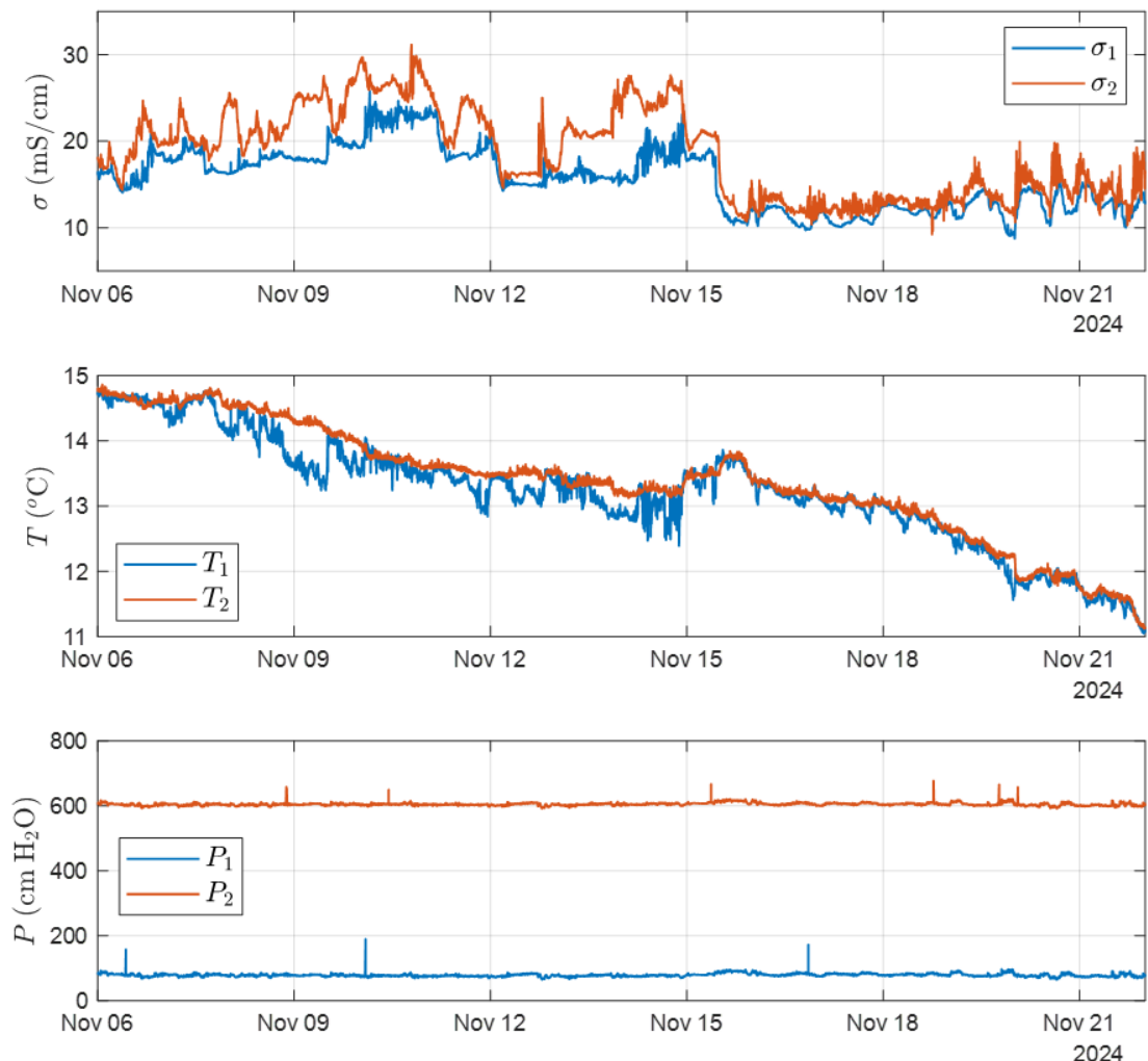
Figuur A.1: Aangeleverde (onbewerkte) meetdata van punt H_x in de periode 6 tot en met 24 november 2024: geleidbaarheid (boven), watertemperatuur (midden) en druk (onder).
