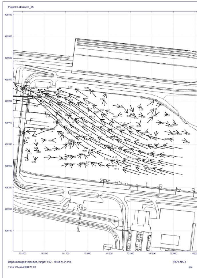
Figuur 2-3 Dieptegemiddelde stroming naar Gemaal IJmuiden bij een debiet van 220 m 3 /s [9].
