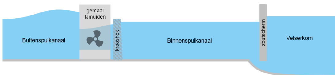
Figuur 1-2: Zijaanzicht van Gemaal IJmuiden, met aan de bovenstroomse zijde het krooshek en het zoutscherm.
