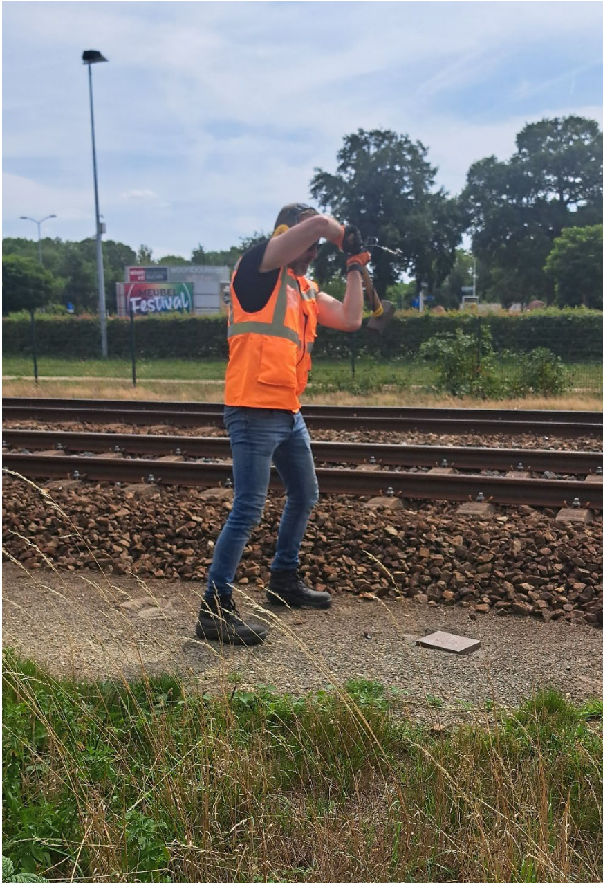
Figuur 2.6 Medewerker van ProRail voert hamerslagen op een metalen plaat uit vlak naast het spoor. De medewerker heeft een speciale veiligheidstraining doorlopen om te mogen werken nabij het spoor.
