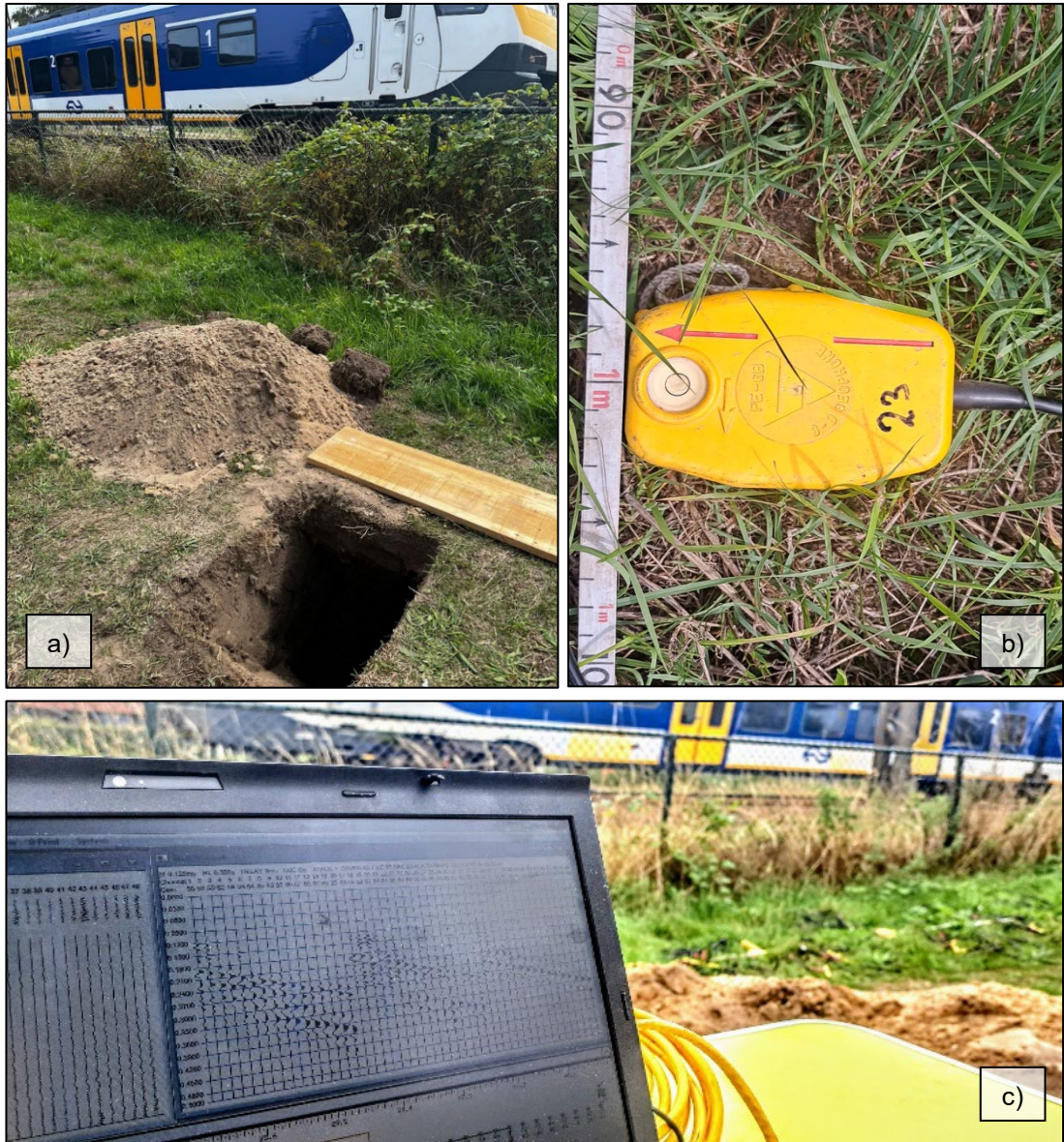
Figuur 2.5 (a) Het gegraven hol en een passerende trein, (b) Driecomponenten gefoon, (c) Trillingen van de gefoons komen binnen in het opnamesysteem.
