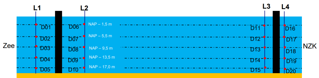
Figuur 2.3: Sensorposities en naamgeving. In het figuur zijn de hoogtes van de sensoren weergegeven zoals is gehanteerd in de periode 20 februari – 15 maart. In de daarop volgende periode (15 – 20 maart) hingen de sensoren van meetlijn L1 0.32 m hoger dan aangegeven in het figuur (Deltares, 2023b).
