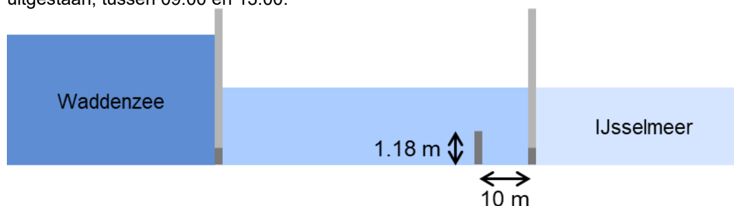
Figuur 2.12: Schematische weergave van de opstelling met de extra drempel.
