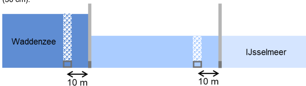
Figuur 2.11: Schematische weergave van de opstelling met \Delta -luchtbellenschermen.
