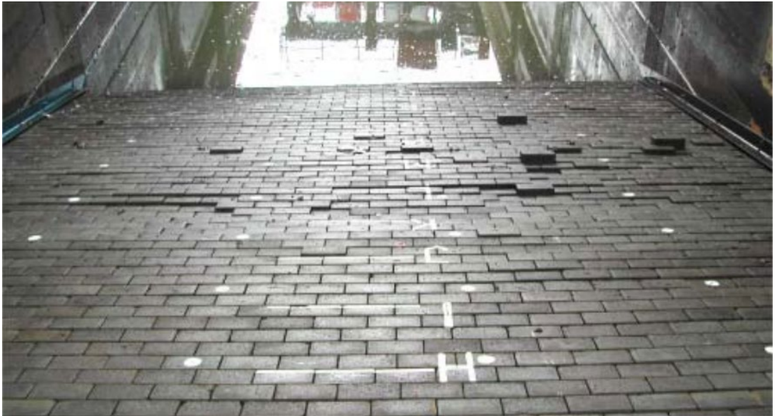
Figuur 1.4 Een voorbeeld van los-blok-falen (de situatie na proef P4120 van Deltagootonderzoek 2005, [8]).
