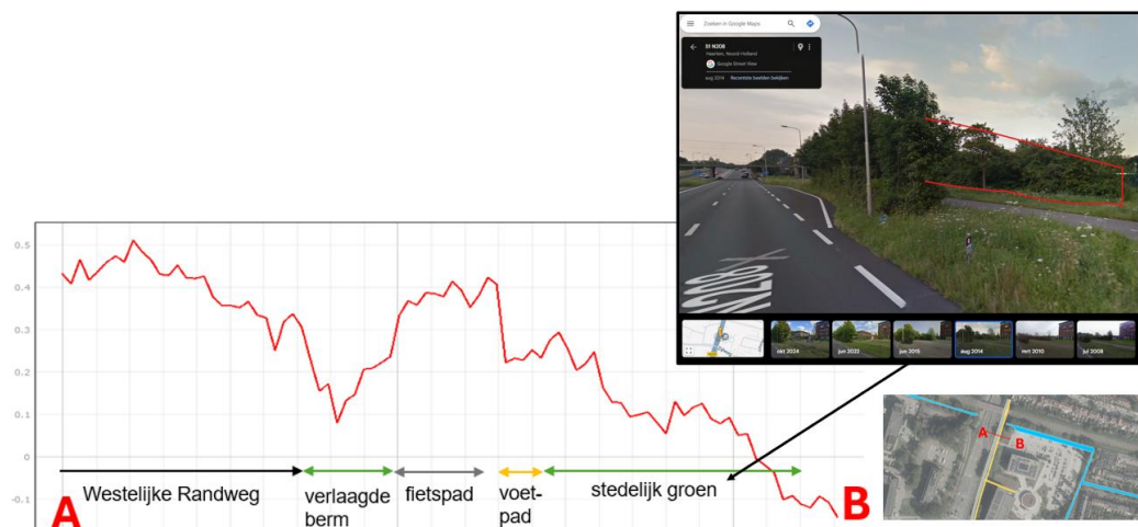
Figuur 3-6: Hoogteverloop in het AHN3 (2014) vanaf de Westelijke randweg via het fietspad, voetpad richting het Nova college. Foto uit 2014 van het stedelijk groen naast het voetpad (bron: Google Streetview).
