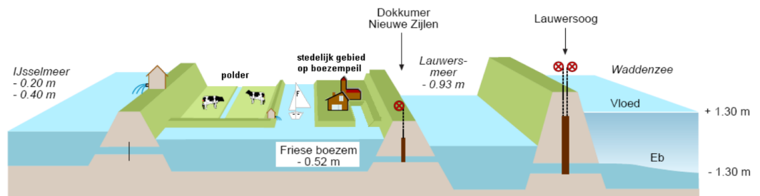
Figuur A-1 Schematische weergave van de werking van de Friese Boezem (Bron: Friesland kaartbeeld Wateroverlast basisgebeurtenis, te downloaden van: Grootschalige extreme regen )
