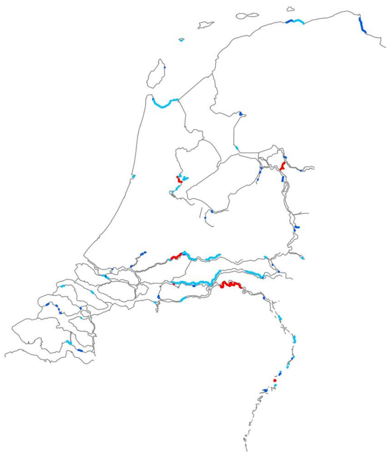
Figuur 5.5 Uitgevoerde dijkversterkingen (donkerblauw), geplande dijkversterkingen tot 2030 (lichtblauw) en dijkversterkingen welke gepland staan tot aan 2030 en die toegevoegd zijn t.o.v. de planning van vorig jaar (toen tot 2029) (rood) (hierin zijn geen dijkdelen die volgens HWBP zijn afgehandeld zonder realisatiefase opgenomen).
