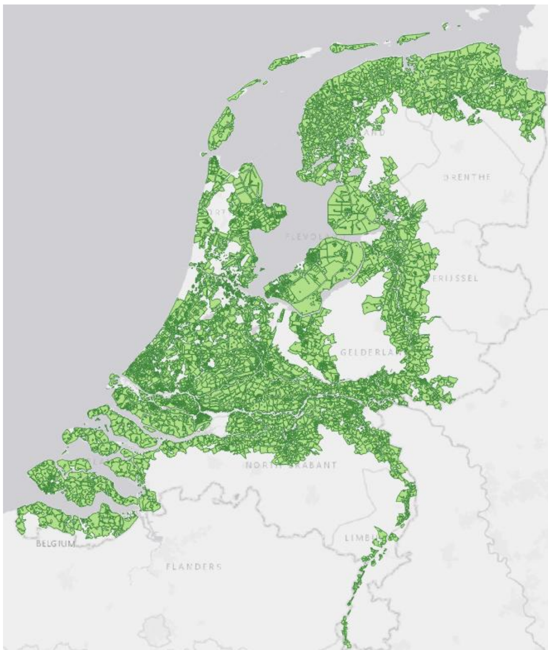
Figuur 4.2 LIR kaart voor het zichtjaar 2050 gemaakt met de nieuwe set overstromingssimulaties. De groene buurten bieden voldoende basisveiligheid.
