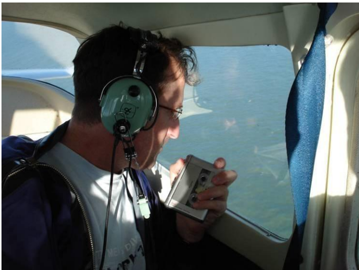
Figuur 3-1 Onderzoeker spreekt zijn waarnemingen op een dictafoon in. Tegelijkertijd logt een GPS de vliegroute. Met afstandsschattingen ten opzichte van het vliegtuig (door middel van waarneemstrips afgebakend met een clinometer) kan de locatie van de waarneming vastgelegd worden.
