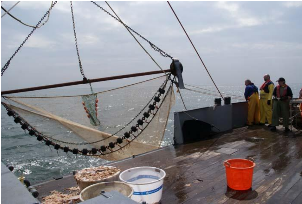
Figuur 2-2 De 6m garnalenkor zoals gebruikt door de "Luctor" (foto: Marcel de Vries, IMARES)
