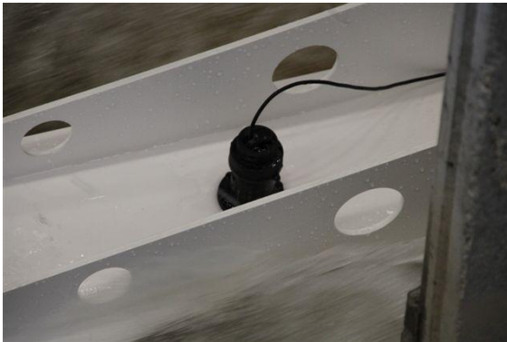
Figuur 2.48 Snelheidsmeter in de surfplank met een golf waarop de surfplank drijft (links); Detail van het schoepenwiel – het wiel is ongeveer 5 mm breed en alleen de onderste centimeter steekt onder de surfplank uit (rechts)
