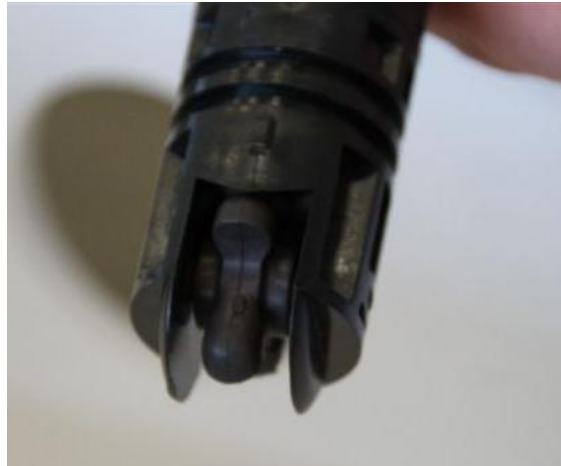
Figuur 2.48 Snelheidsmeter in de surfplank met een golf waarop de surfplank drijft (links); Detail van het schoepenwiel – het wiel is ongeveer 5 mm breed en alleen de onderste centimeter steekt onder de surfplank uit (rechts)
