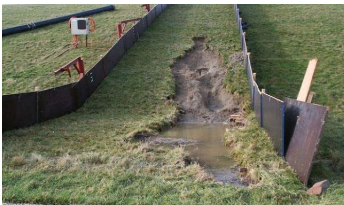
Foto 3.7 Headcut erosie en geulvorming nadat de zode is verdwenen
