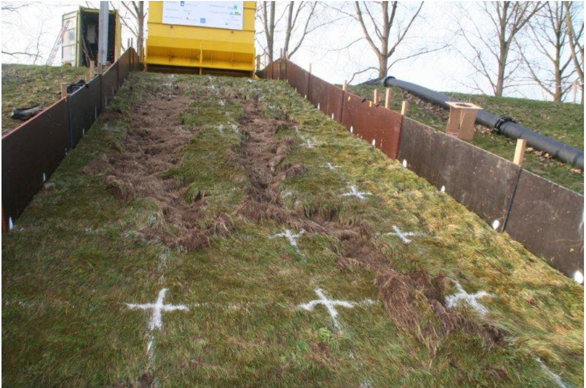
Foto 23. Vechtdijk. Zeer zwaar zeeregime, proef 3; Zand komt vrij door afdeklaag.
