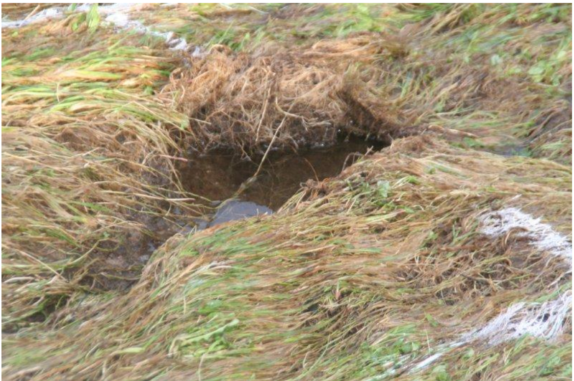
Foto 24. Vechtdijk. Zeer zwaar zeeregime, proef 3; Zand komt vrij door afdeklaag.
