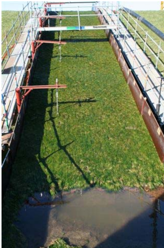
Figuur 38. Boonweg. Sectie 1. Na de proef, geen schade aan het talud wel aan de teen
