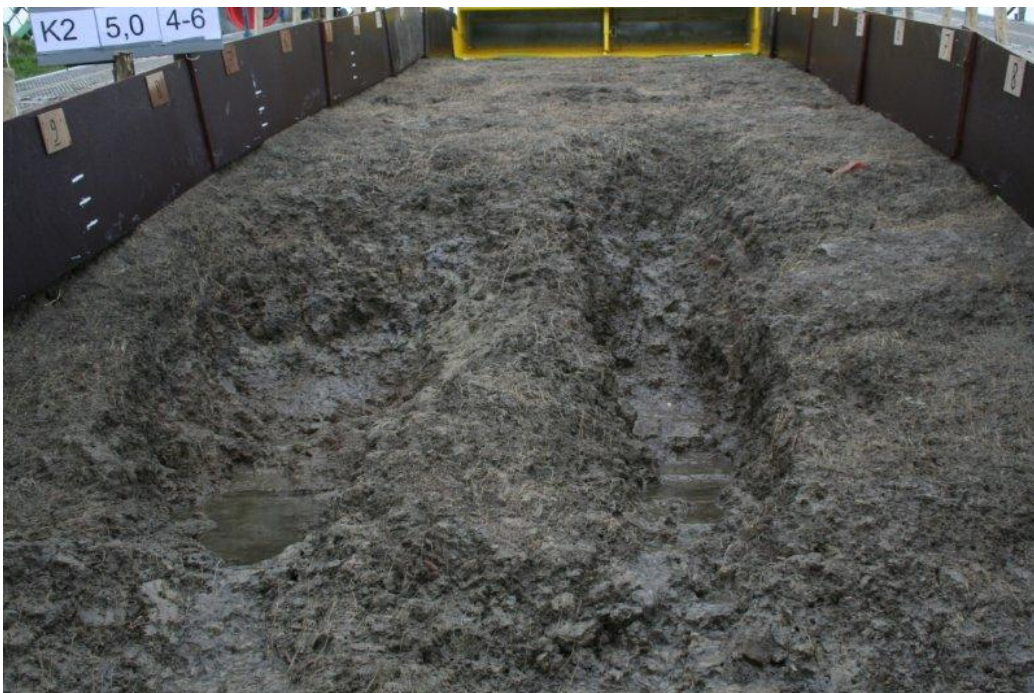
Foto 31. Delfzijl. Kale klei. Net voordat het rechtse gat zich ontwikkelt tot head cut erosie.
