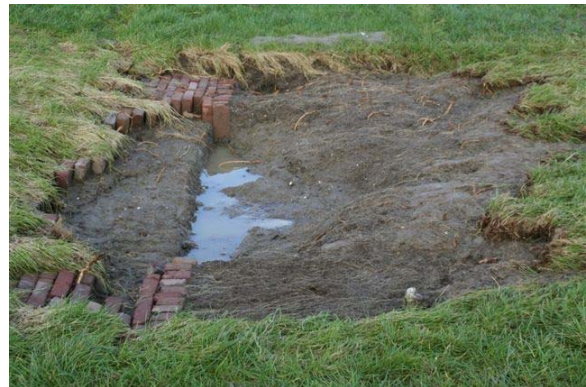
Figuur 38. Boonweg. Sectie 1. Na de proef, geen schade aan het talud wel aan de teen
