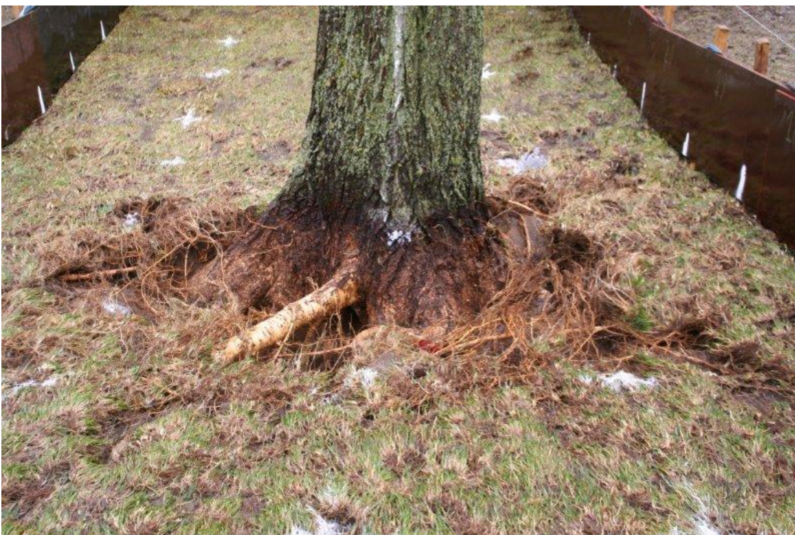
Foto 18. Vechtdijk. Zeeregime met boom, proef 2; Grote erosie boomwortels, zand komt vrij.
