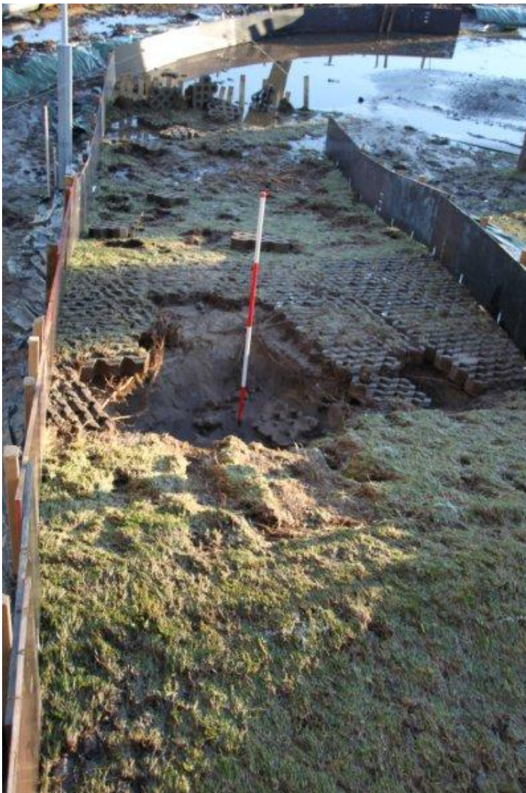
Foto 12. Vechtdijk. Zeeregime met overgang, proef 1; Proef gestopt, overgang bezweken.
