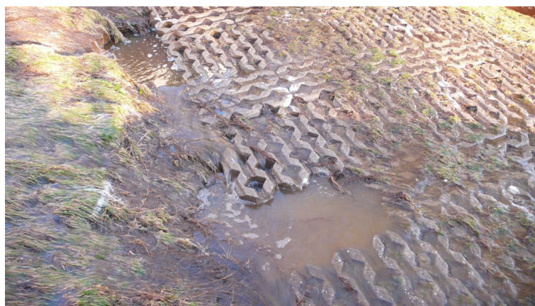
Foto 3.1 Proefstrook 1: ontstaan van Doorgroeisteen t.h.v. linkergat weggeslagen gaten aan de bovenstroomse rand van de verharding
