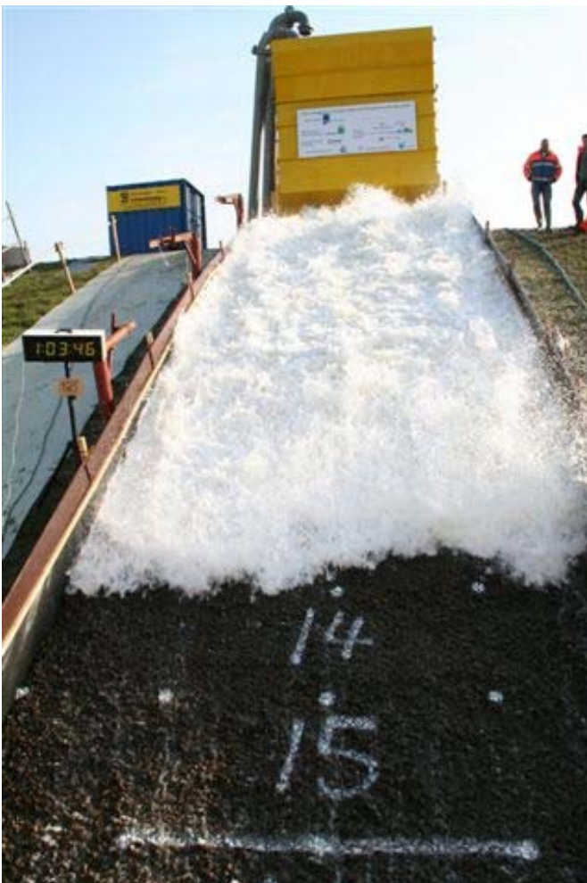
Figuur 49. Kattendijke. Elastocoast. Proef met 125 l/s per m.
