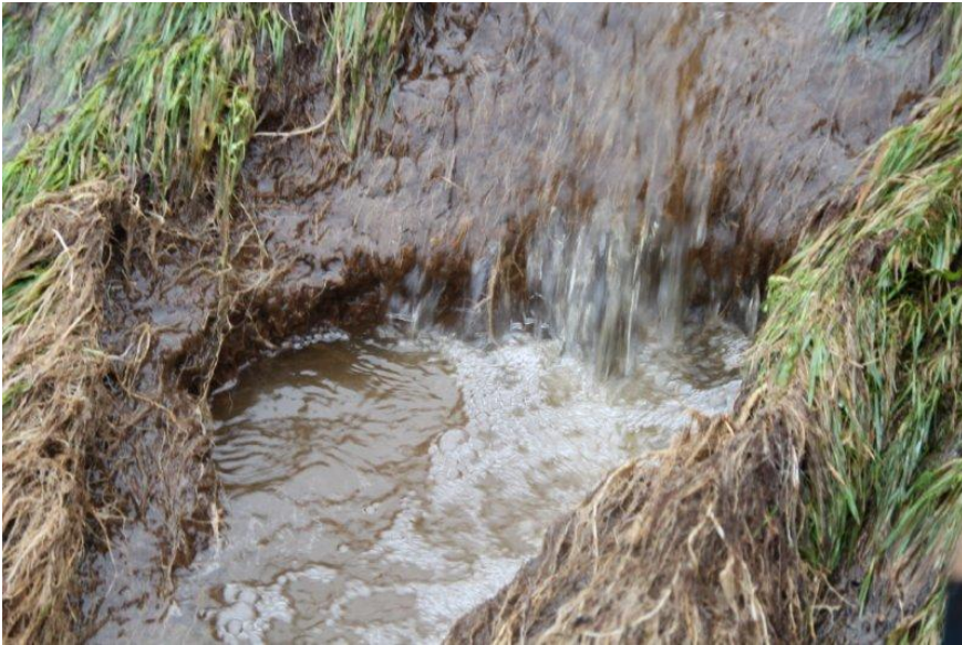
Foto 5. Vechtdijk. Rivierregime, proef 4; Zand komt vrij door afdeklaag.
