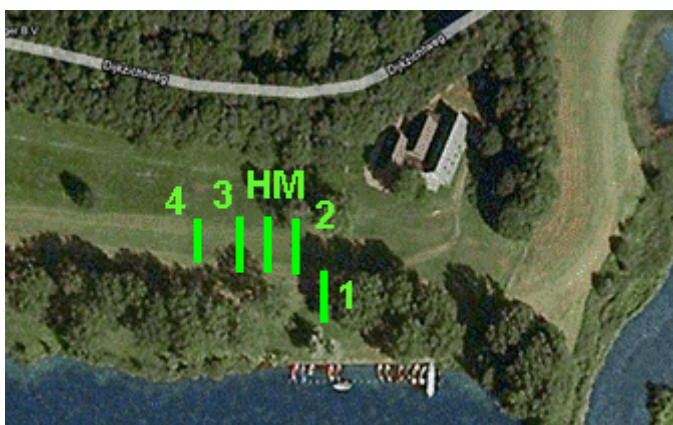
Figuur 4.1 Locatie golfoverslagproeven, alleen bij strook 3 zijn waterspanningsmetingen uitgevoerd.
