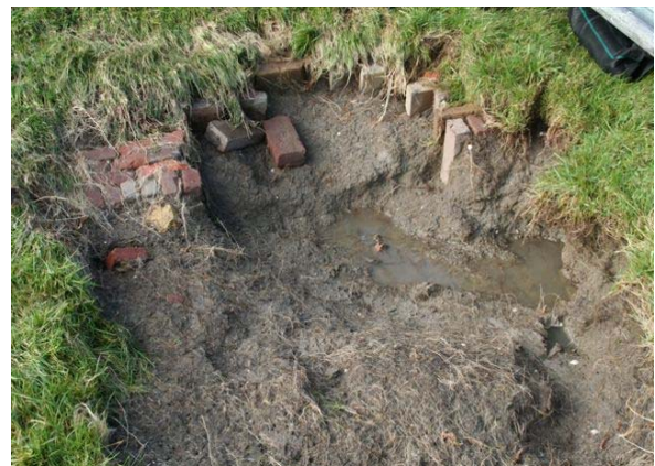
Figuur 39. Boonweg. Sectie 2. Na de proef, geen schade aan het talud wel aan de teen.
