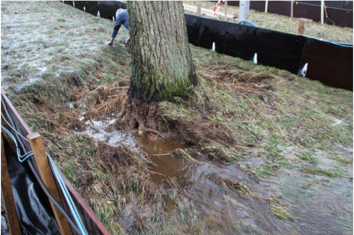
Foto 19. Vechtdijk. Zeeregime met boom, proef 2; Gestopt, headcut erosie bovenstrooms van boom.
