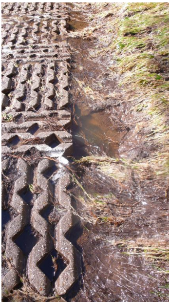
Foto 3.1 Proefstrook 1: ontstaan van Doorgroeisteen t.h.v. linkergat weggeslagen gaten aan de bovenstroomse rand van de verharding
