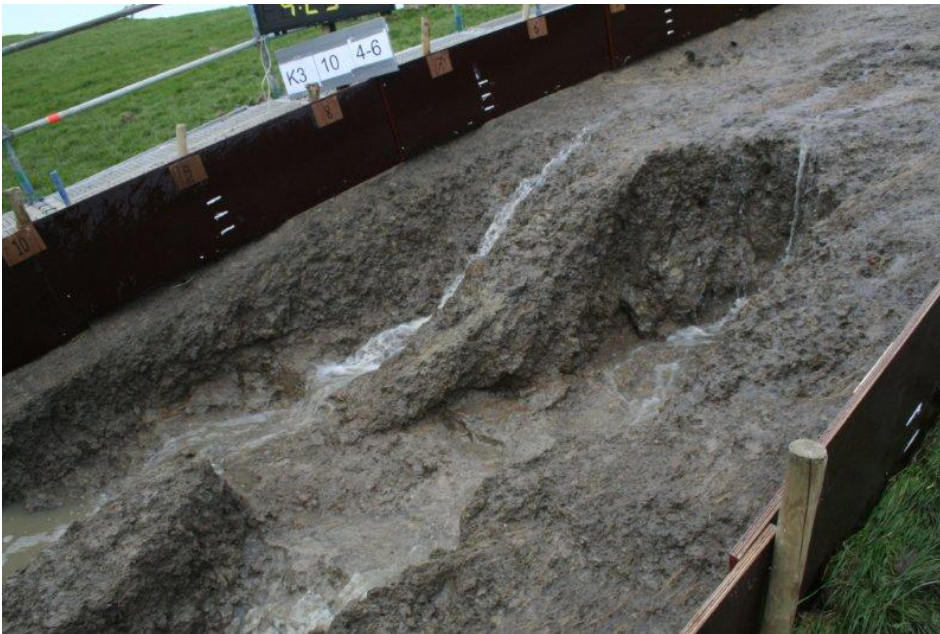
Foto 32. Delfzijl. Kale klei. Ontwikkeling van head cut erosie bij het rechtse gat.
