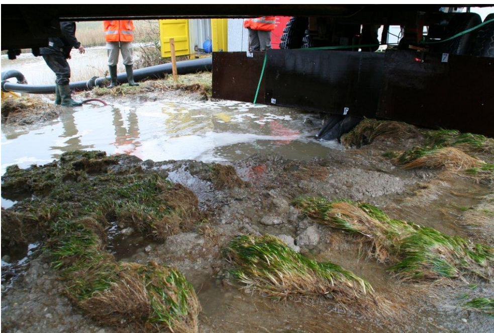
Figuur 45. Kattendijke. Sectie 1. Schade aan teen voordat meetwagen moest worden verplaatst.
