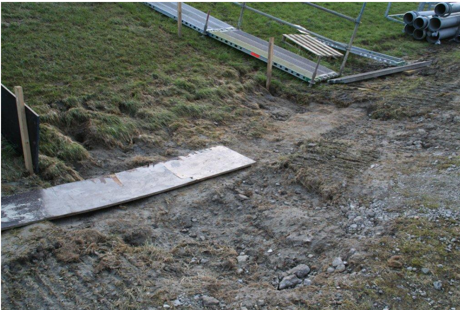
Figuur 48. Kattendijke. Sectie 2. Benedentalud met teen, na de proef. De onderhoudsweg was afgedekt en kon niet worden beschadigd.
