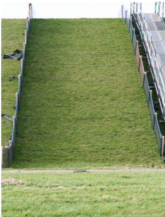
Figuur 39. Boonweg. Sectie 2. Na de proef, geen schade aan het talud wel aan de teen.
