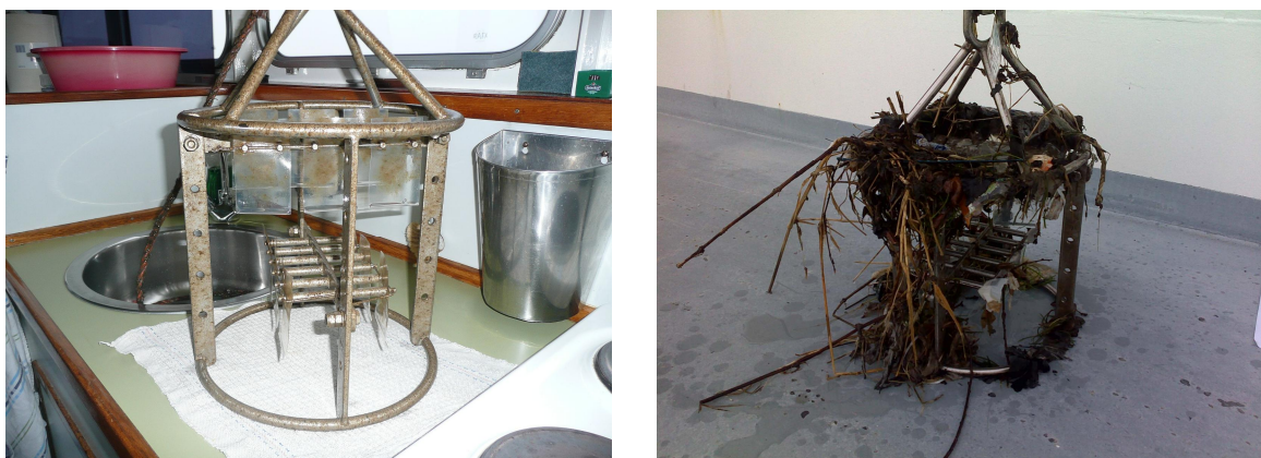
Figuur 2.1 Links een sampler na 3 maanden blootstelling in het Hollands Diep. Rechts; de sampler in de Maas bij Eijsden ving meer dan alleen contaminanten
