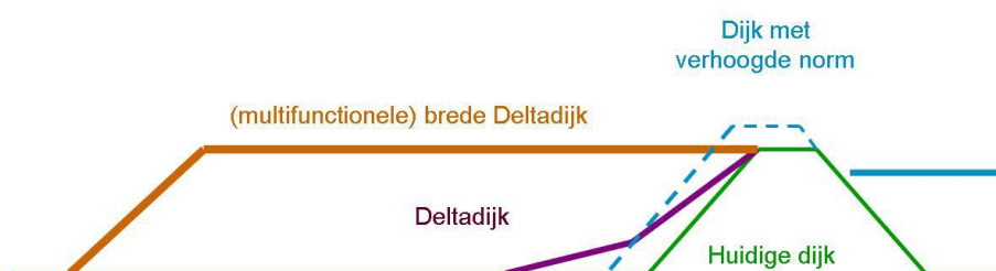
Figuur 4.2 Deltadijk in vergelijking met de huidige dijk, een verhoogde dijk en de multifunctionele brede Deltadijk (bron: De Bruijn en Klijn, 2011)
