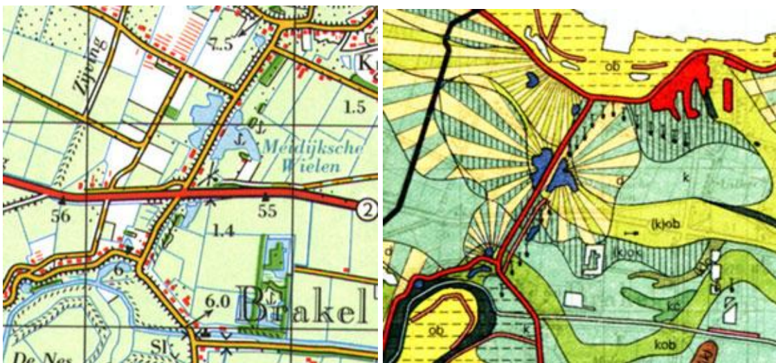
Figuur B.5 Wielen bij de Meidijk, ontstaan als gevolg van een dijkdoorbraak op locatie waar oude stroomrug de dijk kruist (b) (bron: Rhine – Meuse Delta studies, http://www.geo.uu.nl/fg/palaeogeography/results/flooding )
