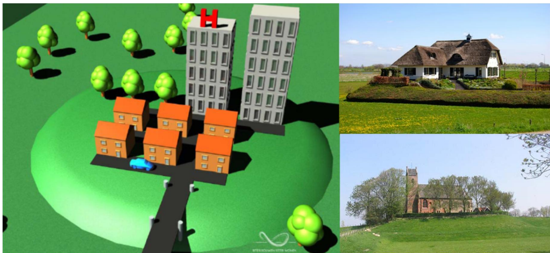
Figuur 4.3 Voorbeelden van integraal of lokaal ophogen
