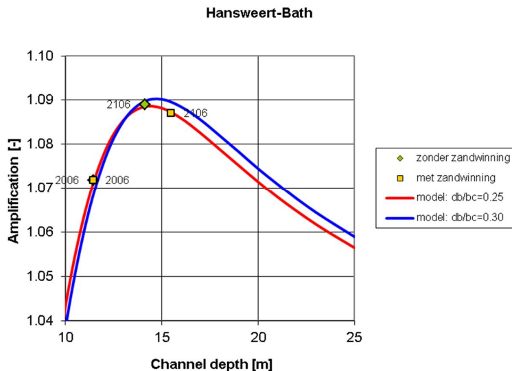
Figuur 4.12c: Analytisch model voor traject Hansweert-Bath. Amplificatie M2-amplitude als functie van de geuldiepte. Zonder zandwinning: groene symbolen; met zandwinning: oranje symbolen. Lijnen: continue verloop voor \Delta b/b_{ch} = 0.25 (situatie 2006) en 0.30 .
