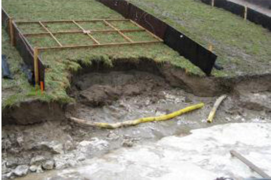
Figure 2.3 Geometrical transitions (Kattendijke)
