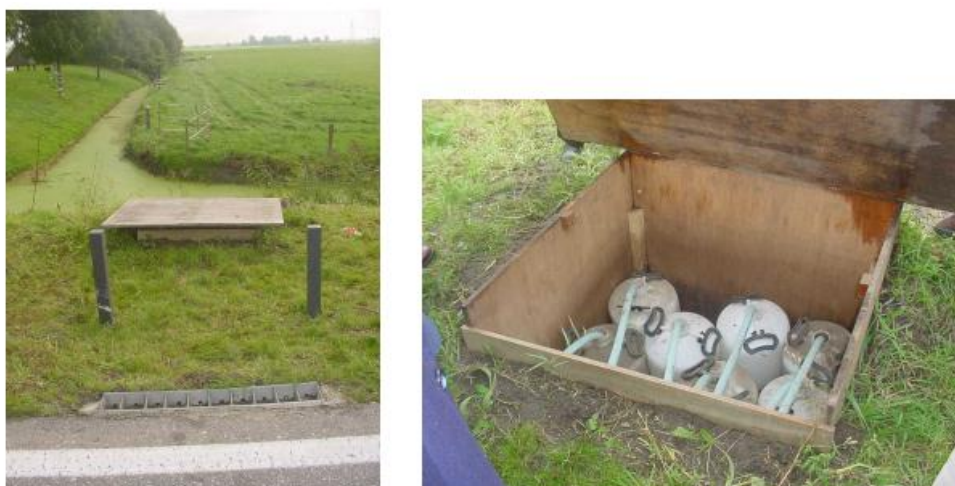
Figuur 4.1 Run-off meter op locatie Bunschoten. Links is de goot te zien aan de rand van de weg met daarachter de kist met monsterflessen. Rechts een detailfoto van de monsterflessen.
