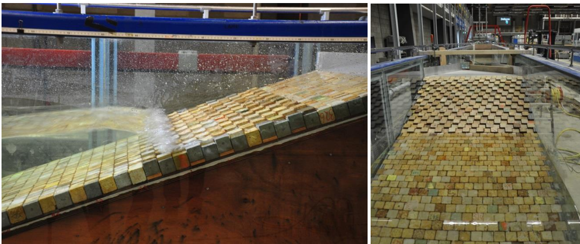
Figuur 3.3 Modelopstelling in Scheldegoot met dambordpatroon
