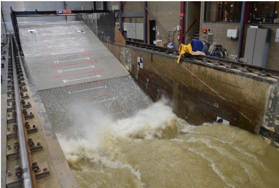
Figuur 2.16 Golfbelasting op Ronaton in de Deltagoot in de Noordoostpolder
