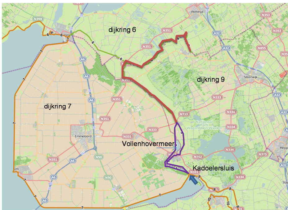
Figuur C.1 De paarse lijn geeft de c-keringen langs Kadoelermeer, Vollenhovermeer en Vollenhoverkanaal. De rode lijn en de groene lijn zijn ook c-keringen. Echter deze staan niet in directe verbinding met het Vollenhovermeer.
