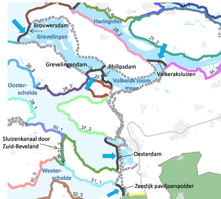
Figuur A.8 Ligging b-keringen in het gebied zuid-westelijke delta. De blauwe peil geeft aan waar de belasting vandaan komt.
