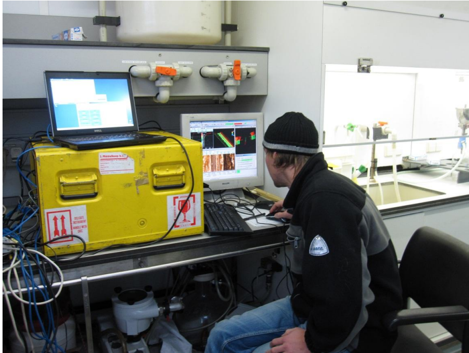
Control-unit (gele box) en monitoren van Hydrochart
