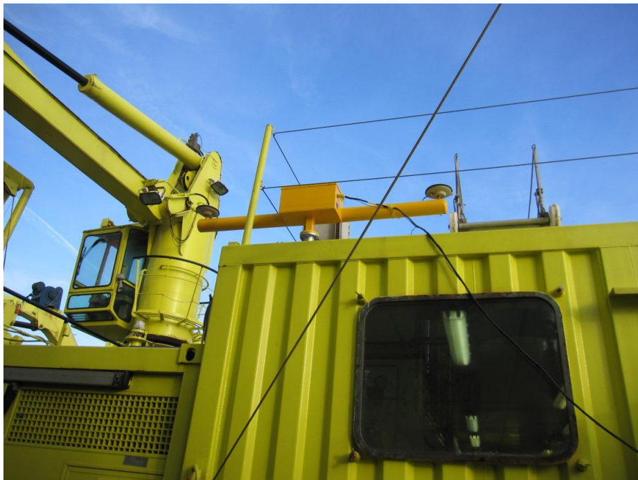
Motionsensor CODA tbv Hydrochart op het dak van de laboratorium-keet
