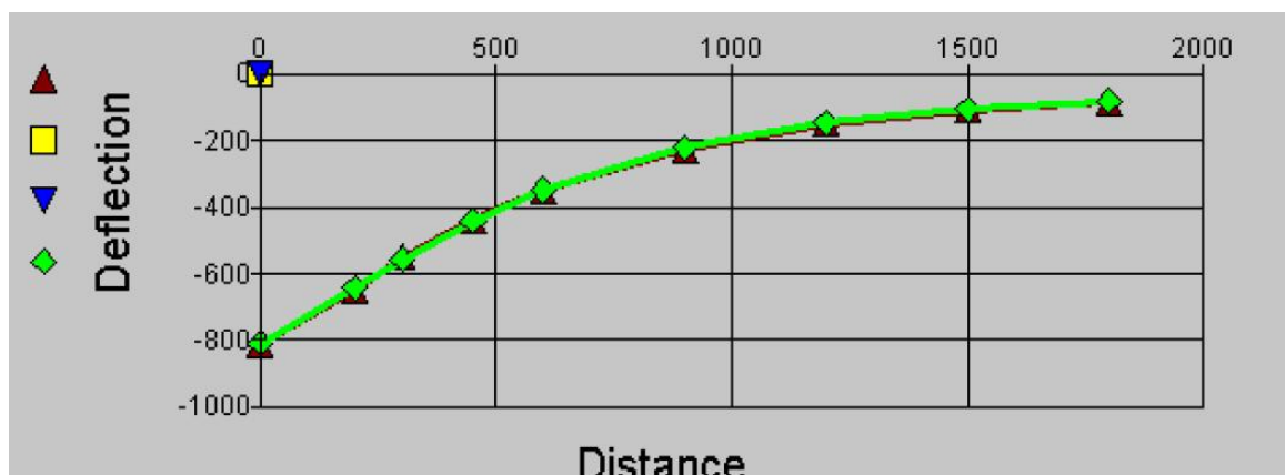
Figuur C.5 Gemeten en berekend deflectieprofiel (deflectie in \mu\text{m} en afstand in mm)
