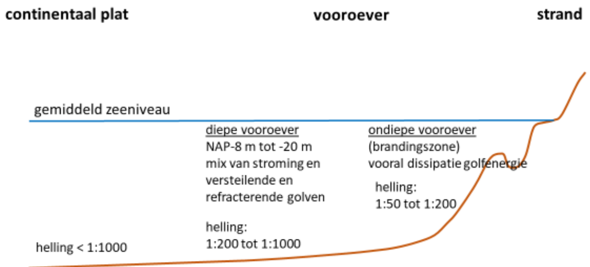
Figuur 2.3 Schematische weergave van een typisch Nederlands kustprofiel (niet op verticale schaal)
