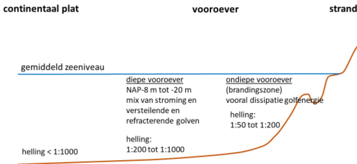
Figuur 2.3 Schematische weergave van een typisch Nederlands kustprofiel (niet op verticale schaal)
