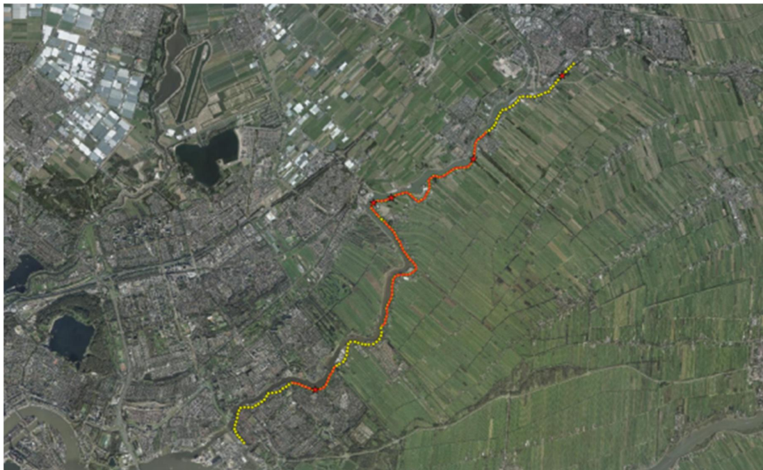
Figuur 1.1 IJsseldijk Krimpenerwaard Krimpen – Gouda (geel – HM aanduidingen dijkkruin; rood scope KJK oktober 2015; (5) rode sterren dwarsprofielen die als case dienen; het middelste profiel is afgefallen
