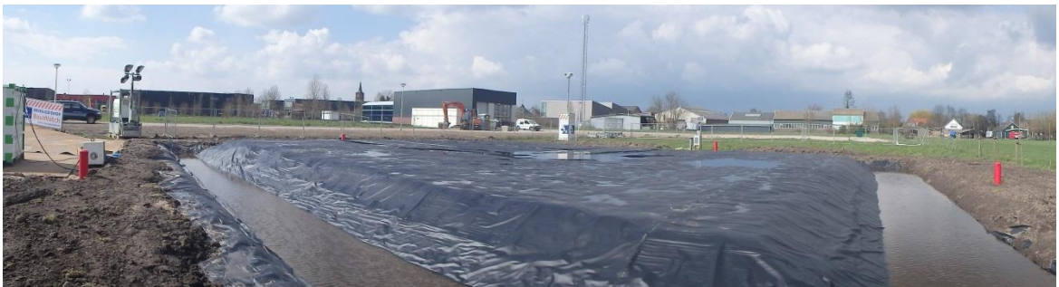
Figuur 3.8 Het proefveld ingepakt in de folie met hellingmeetbuizen (rode kokers)
