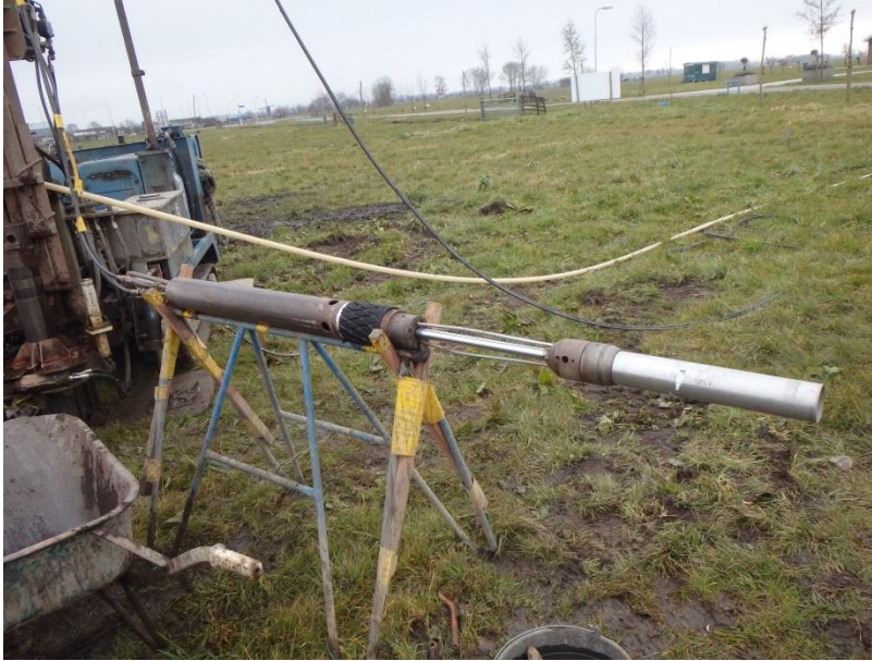
Figuur 4.6 Steekapparaat waarmee de Ackermann bussen hydraulisch gestoken worden
