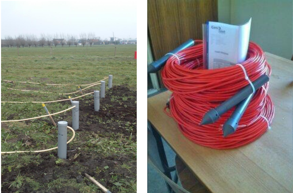
Figuur 4.8: Waterspanningsmeters (op de linker foto met beschermkoker)
