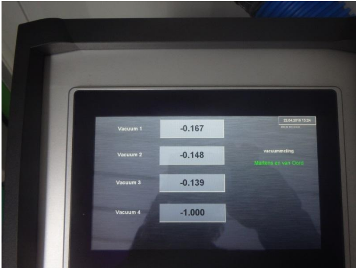
Figuur 3.10 De vacuümdruk wordt digitaal uitgelezen
