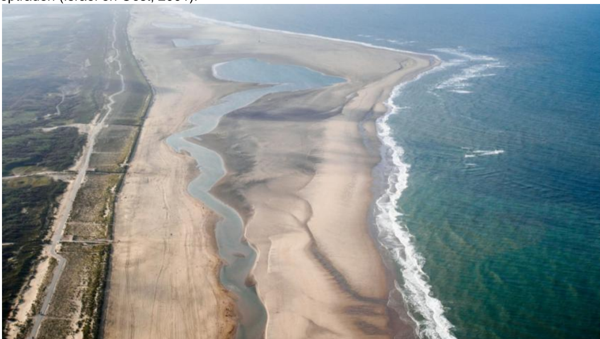
Figuur 4.1 De -vermoedelijk dankzij strekdammen- vrijwel niet meanderende geul van de pilot Zandmotor, 12-11-2015 (RWS, van het Houdt).
