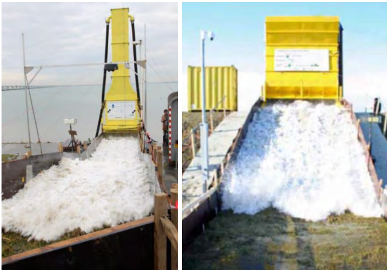
Figuur C.3 Impressie van golfploopsimulator (links) en golfoverslagsimulator (rechts)
