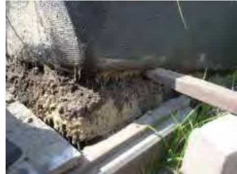
Grasdoorgroeioproef met geotex weefsel. 20 cm grond boven op het weefsel en 20 cm zand en grond onder het weefsel. Na ruim 2 maanden (67 dagen) zeer sterke cohesie met ondergrond door glomaline. Wortellengte onder weefsel 20 cm.
