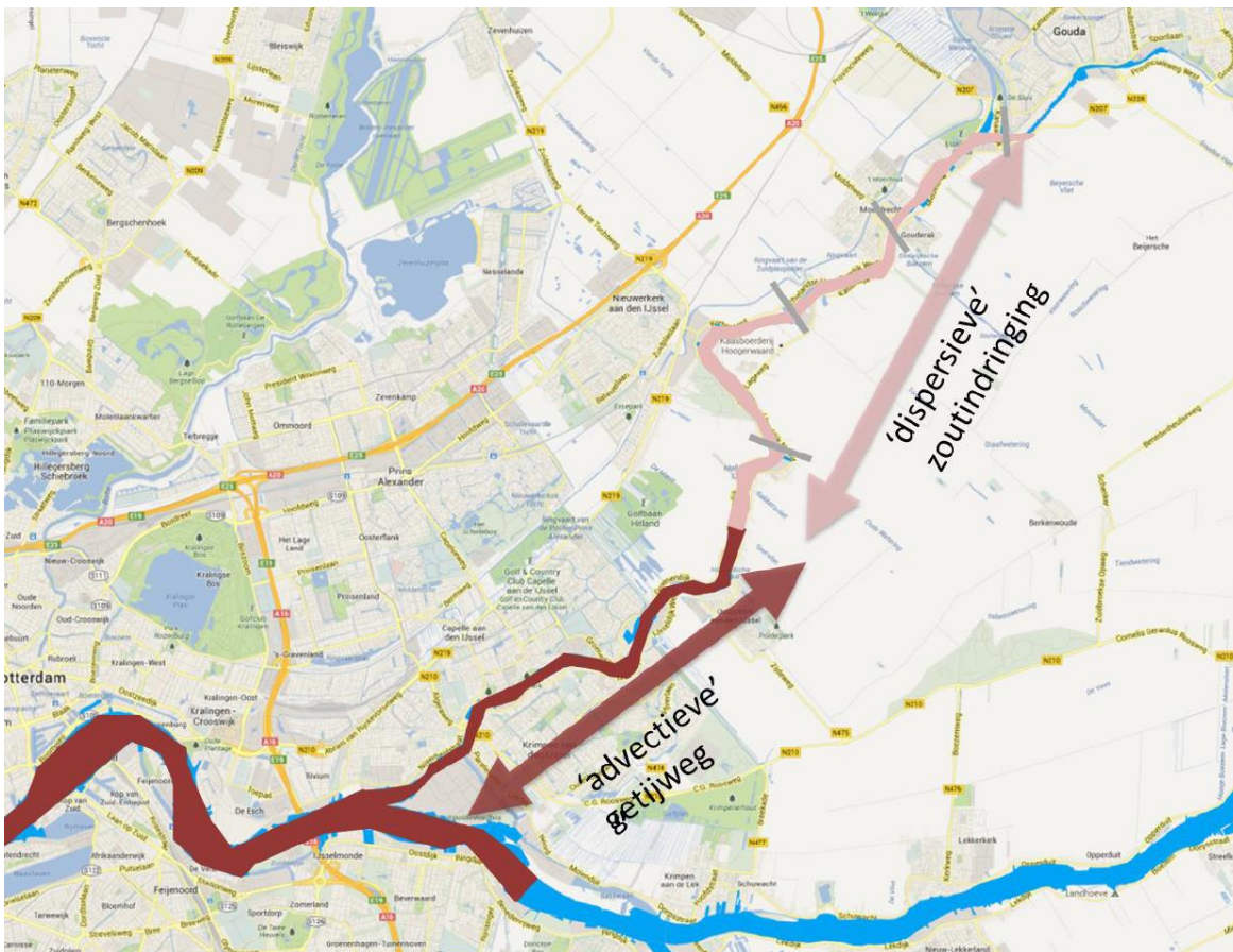
Figuur 2.7 Advectieve getijweg: maximale afstand waarover zout vanuit de Nieuwe Maas door advectie ten gevolge van de getijbeweging kan worden getransporteerd (Hydrologic, 2013). Opwaarts hiervan kan alleen zout voorkomen ten gevolge van dispersieve processen (indien er geen onttrekkingen zijn).
