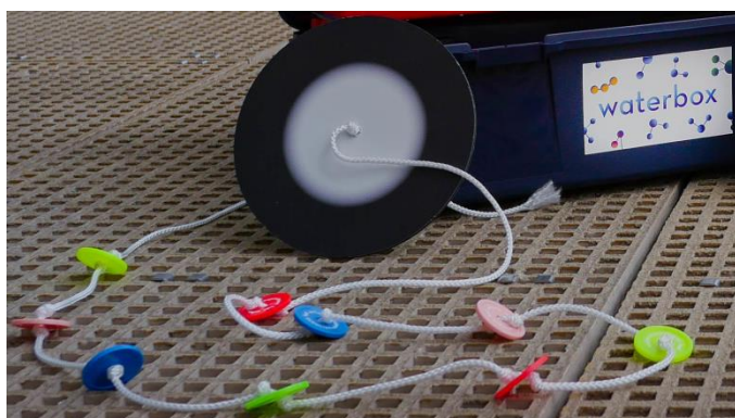
Figuur 2.5. Links: doorzicht wordt bepaald met behulp van een zwart-witte schijf en touw waarop met fiches een maatverdeling is gemaakt. Rechts: de FU-kleurenschaal is op een kaart gedrukt om de kleur van water te bepalen (Uitsnede foto van deelnemer Jnieuwland).
