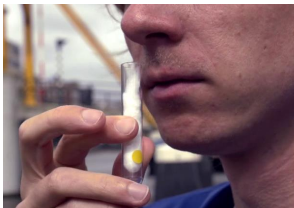
Figuur 2.6. Links: Met een thermometer wordt de temperatuur bepaald. Rechts: De geur van het water wordt vergeleken met vijf referentiegeuren in de vorm van geurolie in buisjes (beiden beelden uit instructievideo's van HSWE)
