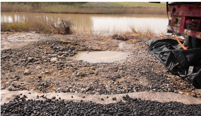
Figuur 10-3 Beschadiging onderhoudsweg (links) en gat achter onderhoudsweg (rechts) na uitvoering proeven op open steenasfalt
