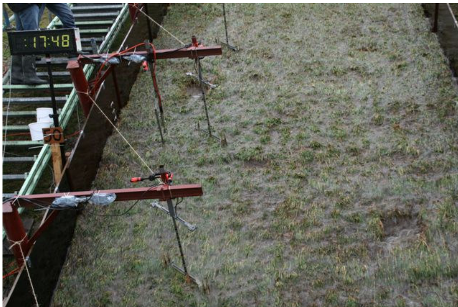
Figuur 4.1 Initiële schade Philipsland bij de start van 50 l/s per m.
