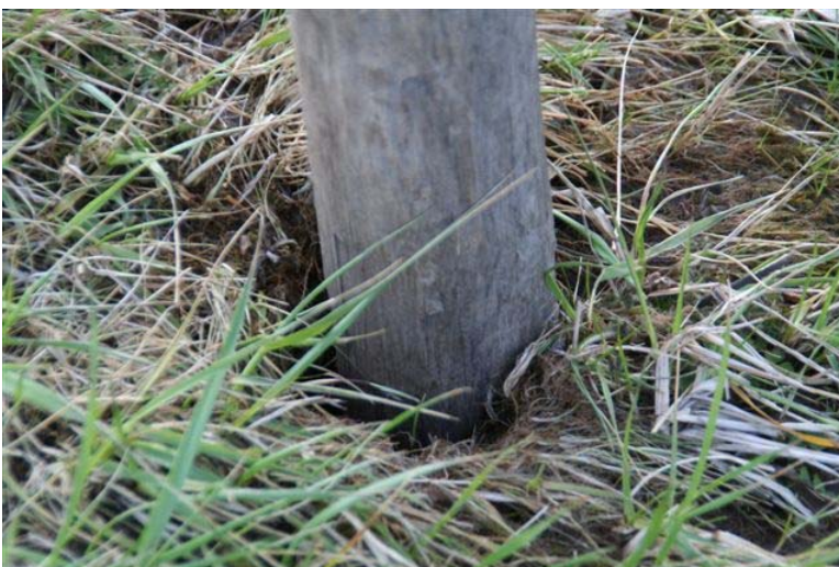
Figuur B24. Eindresultaat Kattendijke; sectie 2, na 50 l/s per m. Er waren twee palen geplaatst, een op de kruin en een midden op het talud. Rondom de paal op de kruin ontstond hele lichte erosie, geen doorgaande schade.
