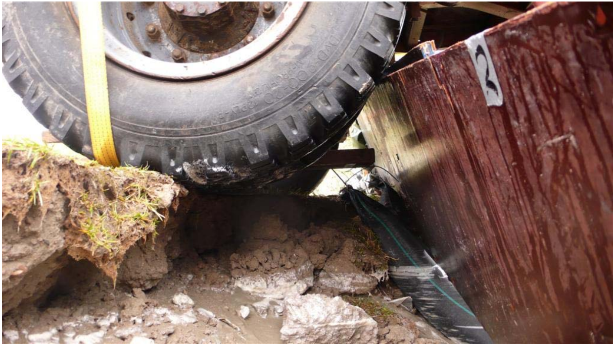
Foto F-10 Tijdens de eerste twee uur van de proef met 75 l/s per m is de proef onderbroken omdat het gevaar bestond dat de meetcabine ondermijnd zou worden.
