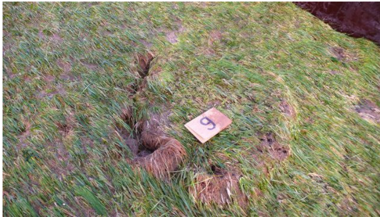
Figuur 4.5 Kattendijke; proefvak 2 na 2 uur met 50 l/s per m. De paal was er uit geslagen en een grasplag is opgedrukt en enigszins verschoven in benedenwaartse richting.
