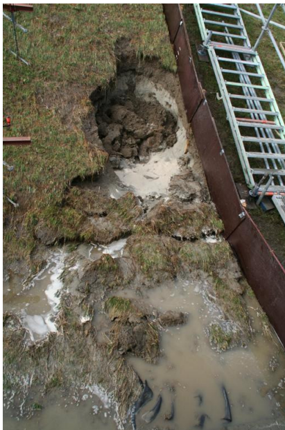
Figuur 7-7 Eindresultaat na 50 l/s per m
