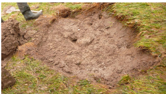
Figuur 9-5 De onder de uitgraven moot aanwezige mollengaten
