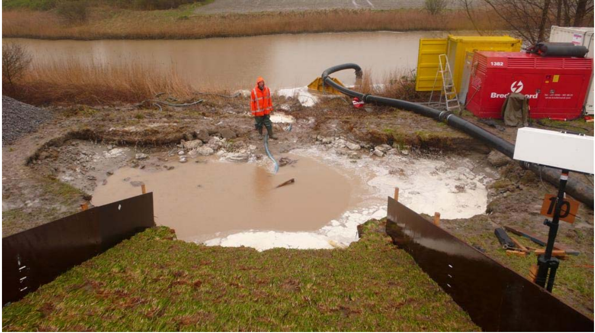
Foto F-13 Het eindresultaat na bijna 6 uur "golven" met 75 l/s per m.
