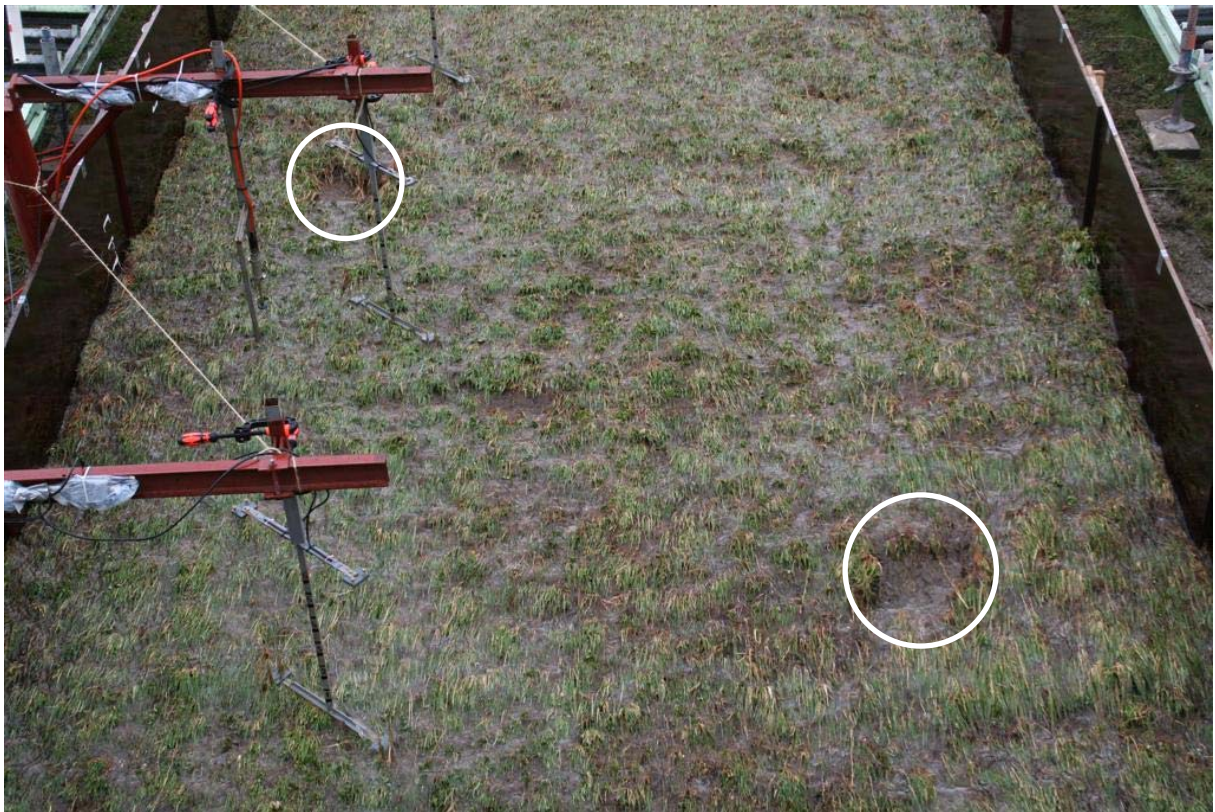
Foto F-2 Vrijwel aan het begin van de proef met 50 l/s per m vond op een tweetal plekken gelijktijdig substantiële erosie plaats door één enkele grote golf.
