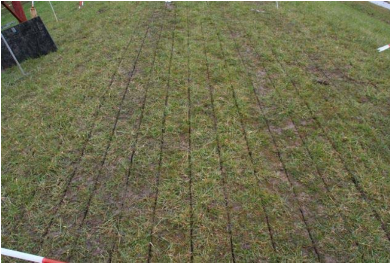
Figuur B22. Kattendijke, sectie 2, voor begin proef. Sneden van een gierinjecteur, aangebracht op kruin, teen en ondertalud, niet op het middelste deel van het talud.
