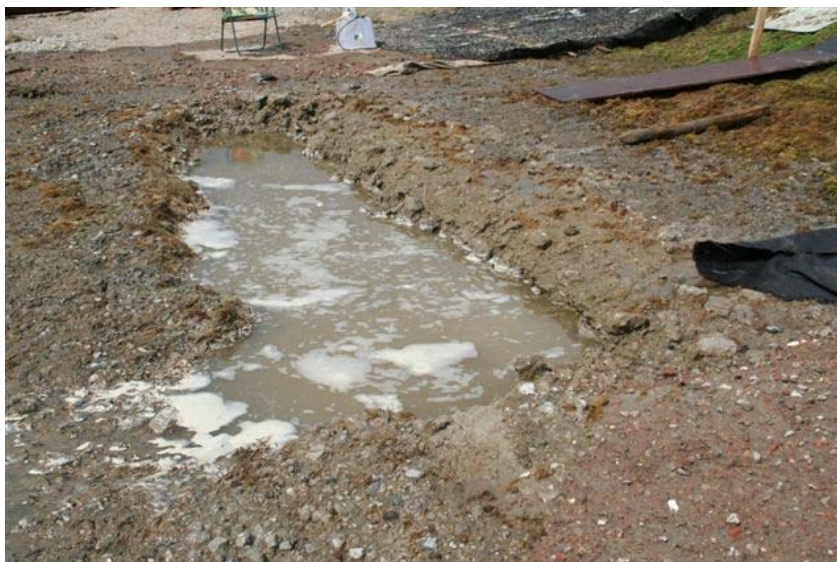
Figuur B32. Kattendijke, demonstratie na afloop van de proeven. Op 16 april zijn 17 watermanagers uit Florida op bezoek geweest. Op een nieuwe sectie werd gedurende 20 minuten ter demonstratie met 75 l/s per m gegolfd. In deze tijd ontstond een gat in de onderhoudsweg met een diepte van orde 0,5 m.
