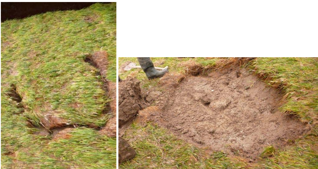
Figuur B27. Eindresultaat Kattendijke; sectie 2, na 50 l/s per m. Uiteindelijk werd klei onder de plag geërodeerd, maar zat de plag voldoende vast om er niet uit te slaan. Uiteindelijk zakte de plag na erosie van klei naar beneden en kwam weer gelijk met het talud te liggen. Rechts na uitgraving (dus niet ontstaan door de proef!). De paal was precies in een stelsel van mollengangen gezet, die wel 50 cm diep gingen.
