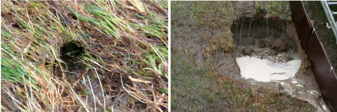
Figuur B14. (Links). Eindresultaat St Philipsland, na 50 l/s per m. Het mollengat was vanaf het begin van de proeven zichtbaar, maar heeft nooit tot verdere schade geleid.
