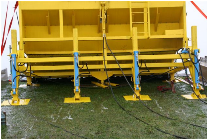
Figuur 3-8 De simulator van achteren gezien, met het onderstel en de hydraulisch verstelbare poten.
