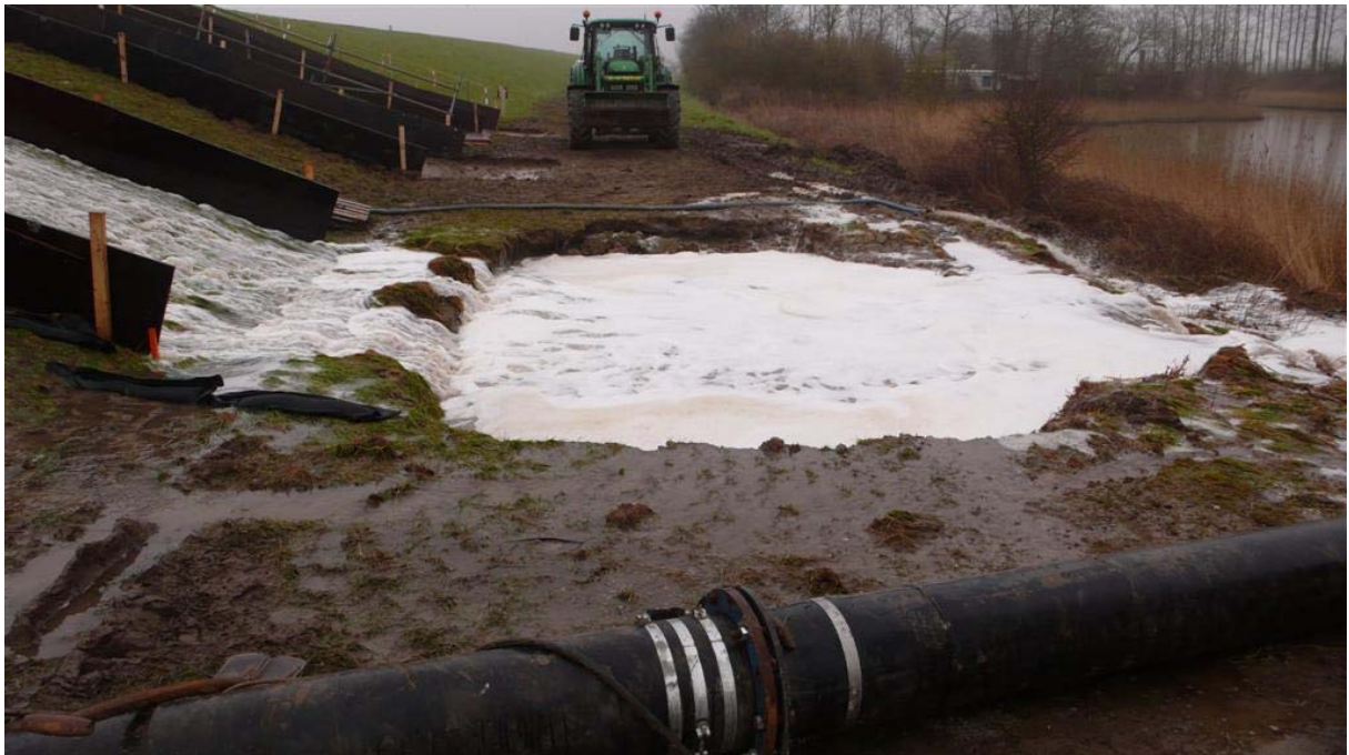
Foto F-11 Het gat achter de onderhoudsweg werd opgevuld met mijnsteen, welke na hervatting van de proef bij enkele grote golven al weer was verdwenen. Het gat in de onderhoudsweg kon zo gedurende de sessie groter en dieper worden.
