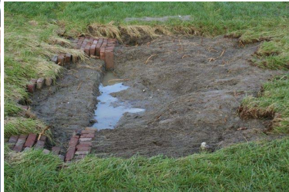
Figuur B3. Eindresultaat Boonweg, eerste sectie. Kleidek van 0,6 m op zandkern. Normaal beheer (hele zomerseizoen beweiden, bijmaaien en 70 kg/hectare stikstof). Geen schade aan talud na 75 l/s per m; Na 4 uur van 50 l/s per m beschadiging horizontale deel (teen), waar een oud klinkerpaadje aanwezig bleek. Deze schade zette zich door bij 75 l/s per m (foto rechts).
