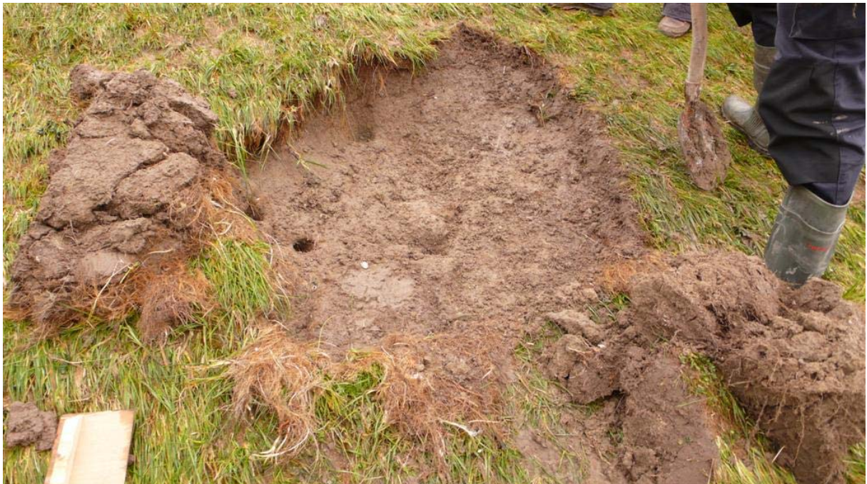
Foto F-17 Aan het einde van de proeven is de moot uitgegraven. Rondom en onder de moot grond bevonden zich mollengaten die tot diep in de kleilaag reikten
