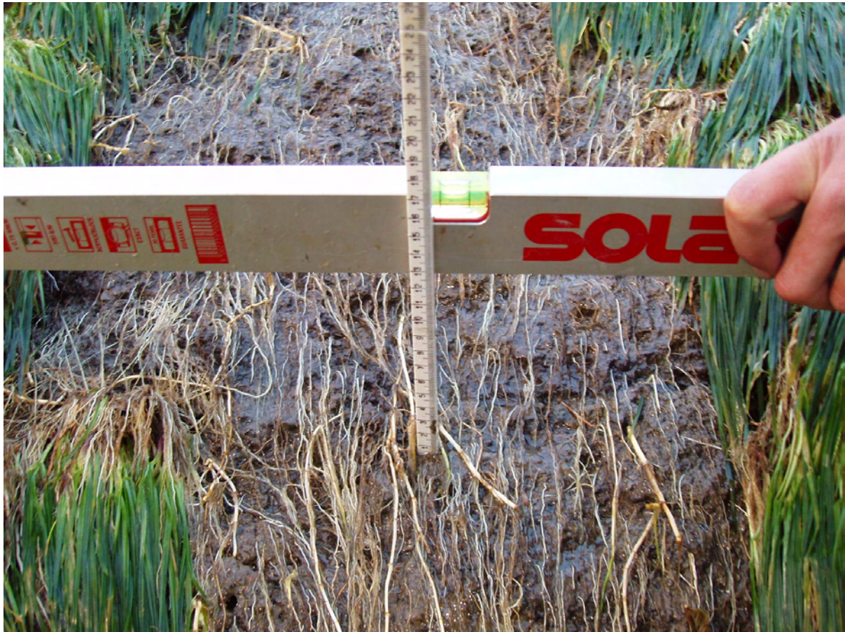
Figuur 10: na afloop van '50' l/s per m proef: detail in geultje, waarbij de wortelresten zeer goed zichtbaar zijn
