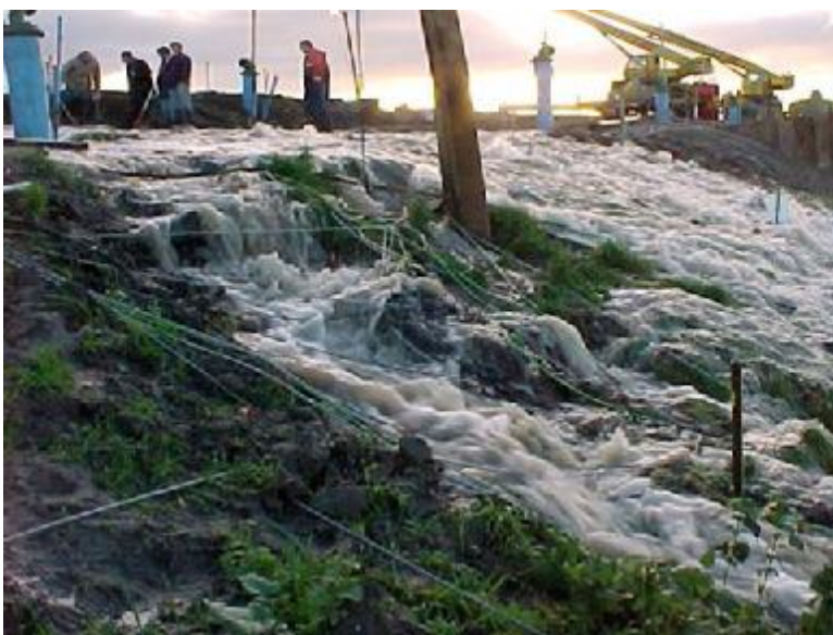
Figuur 2.3: Overlopen van het binnentalud kort voor het einde van de proef.
