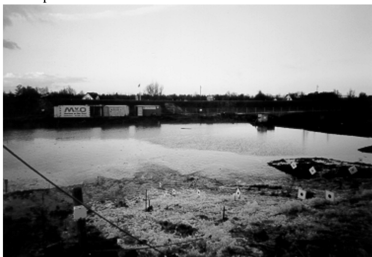
Overlopen van het binnentalud kort voor het einde van de proef, bij maximaal debiet.
