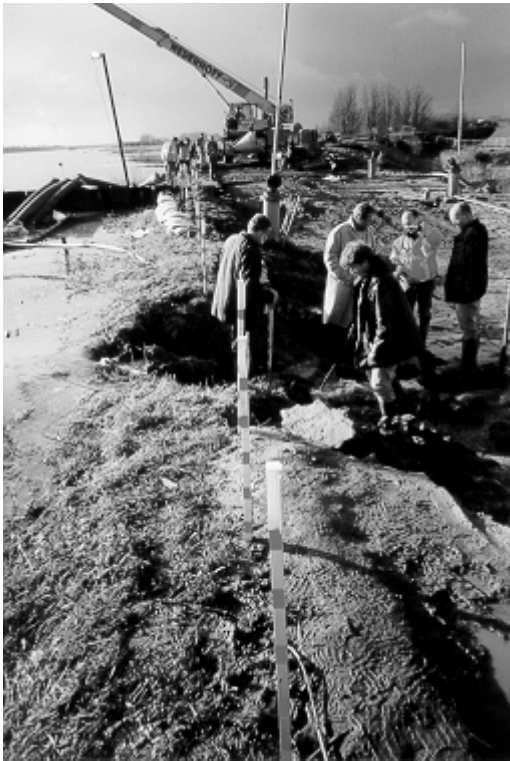
Pauze rond half een, de bres is hoofdzakelijk in de eerste 10 minuten na overlopen ontstaan.
