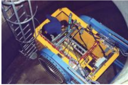
Figuur 3.7 Model in de grote centrifuge.
