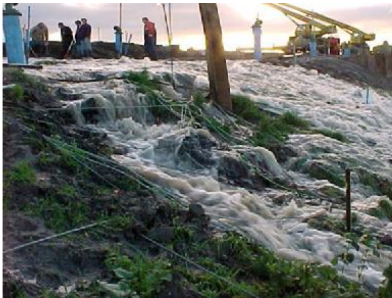
Figuur 7.3: Overlopen van het binnentalud kort voor het einde van de proef.
