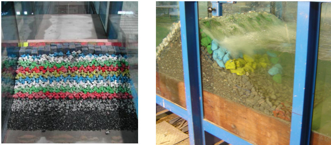
Figuur 3-13: Schaalmodelonderzoek: betonnen elementen (links) en breuksteen (rechts)
