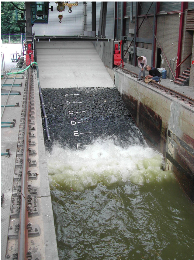
Figuur V-2: Modelonderzoek met een steenzetting in de Deltagoot van Deltares
