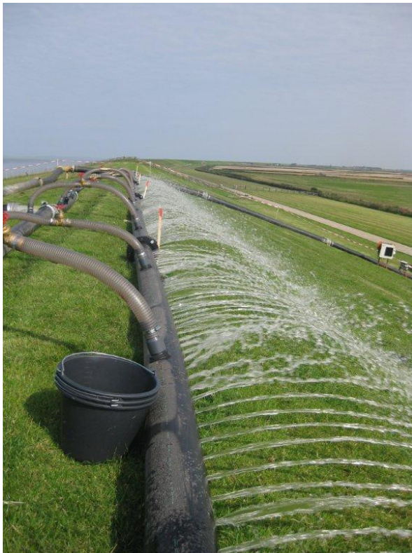
Figuur 4.8 Wateraanbod bij infiltratie en afschuijproef (Friese Waddenzeedijk nabij de Boonweg)
