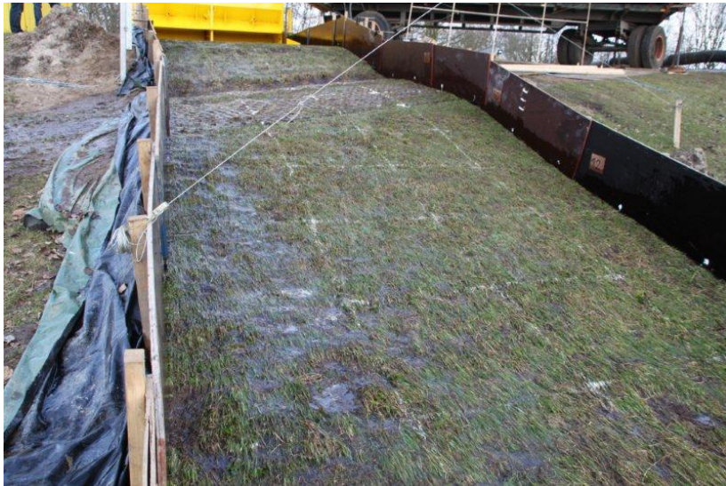
Foto B38. Vechtdijk. Zeeregime met dijkovergang, proef 1; Meerdere locaties kale plekken talud.
