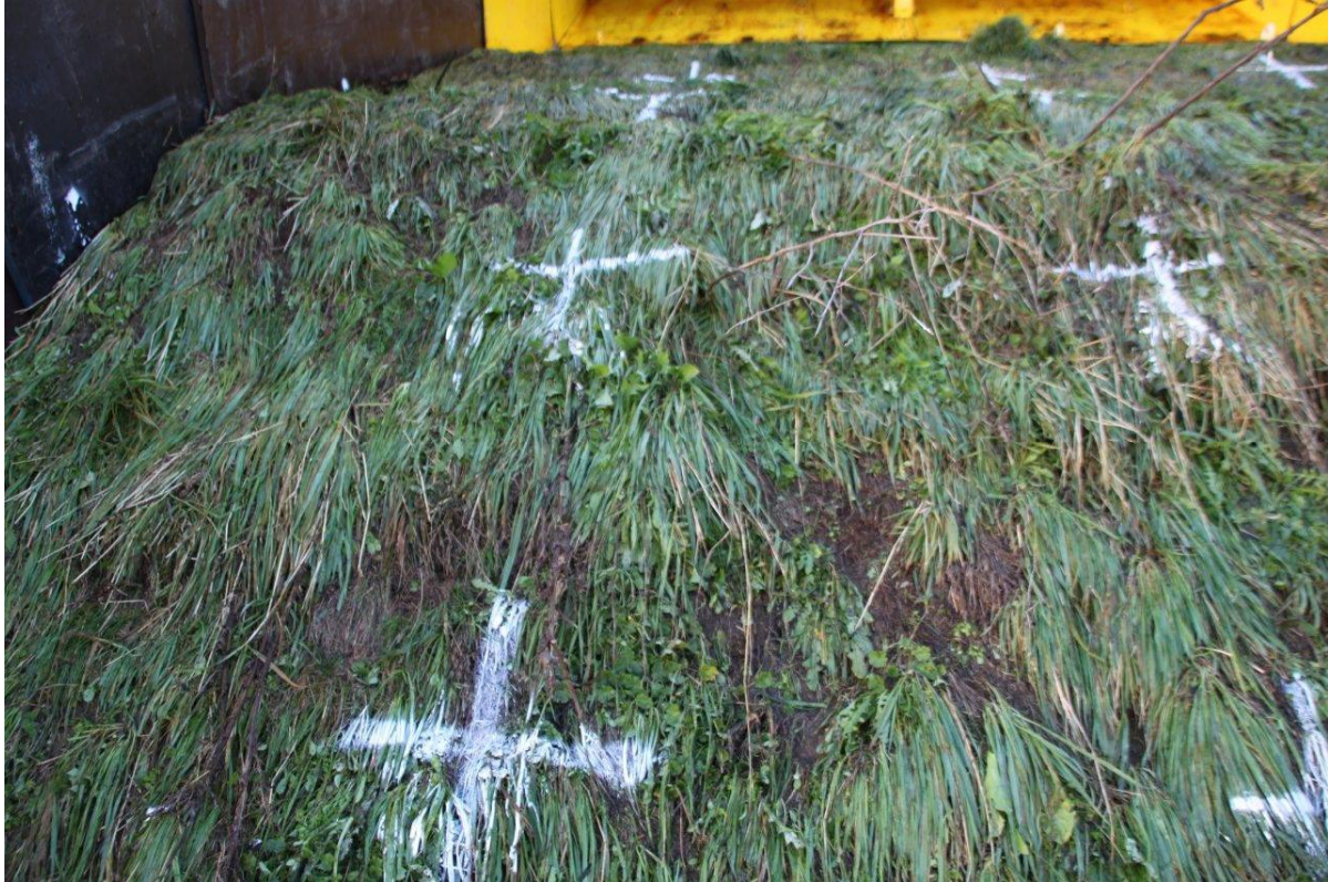
Figuur B69. Tielrode, België. Sectie 1. Begin van schade.
