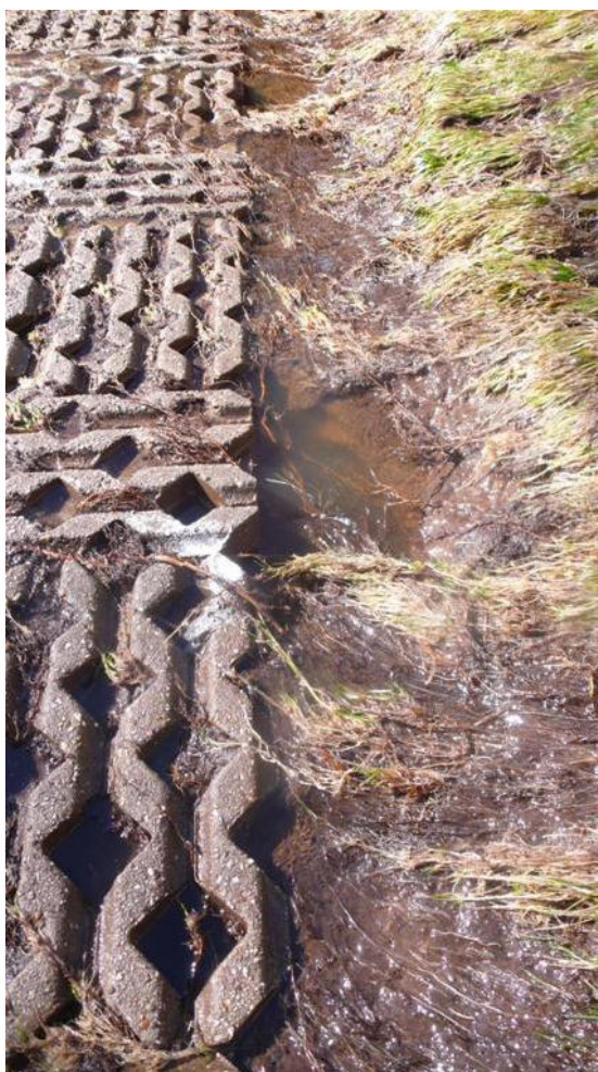
Figuur 8.6 Overgang van talud naar wegovergang met doorgroeistenen (Golfoverslagproeven Vechtdijk)
