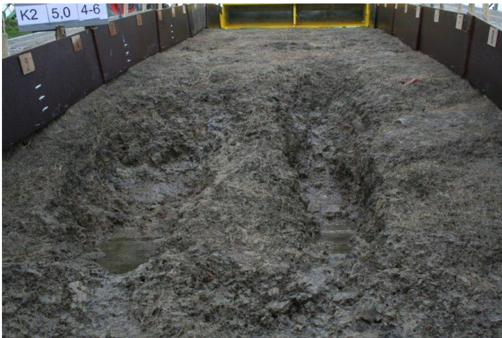
Foto B2. Delfzijl. Kale klei. Net voordat het rechtse gat zich ontwikkelt tot head cut erosie.
