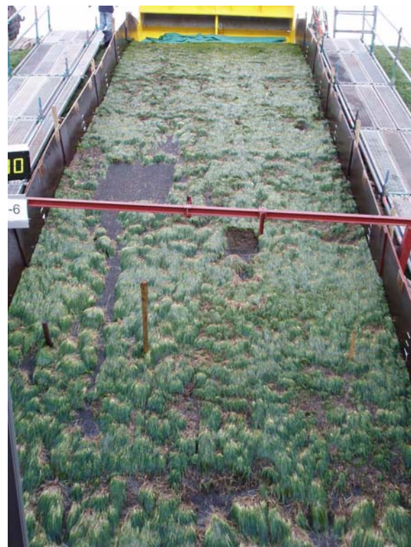
Foto B8. Delfzijl. Grastalud. Afstropen van het gras beneden de initiële schade. Links grastalud, rechts met geotextiel versterkt.
