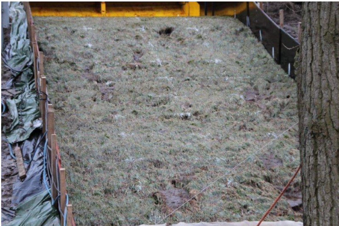
Foto B45. Vechtdijk. Zeeregime met boom, proef 2; Gestopt, talud niet bezwaken.
