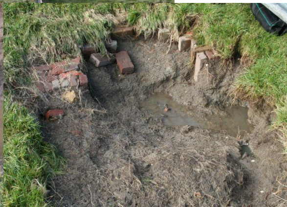
Foto B11. Boonweg. Sectie 3. Na de proef, schade aan het talud en aan de teen.
