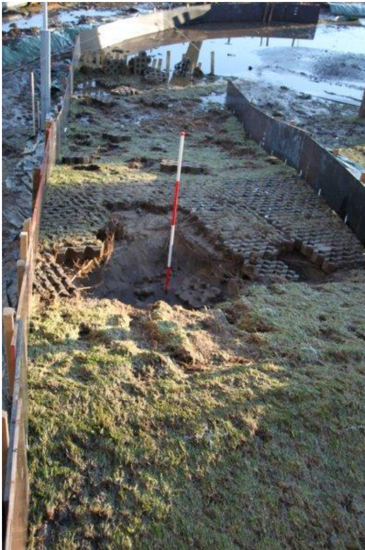
Foto B41. Vechtdijk. Zeeregime met dijkovergang, proef 1; Proef gestopt, overgang bezwaken.
