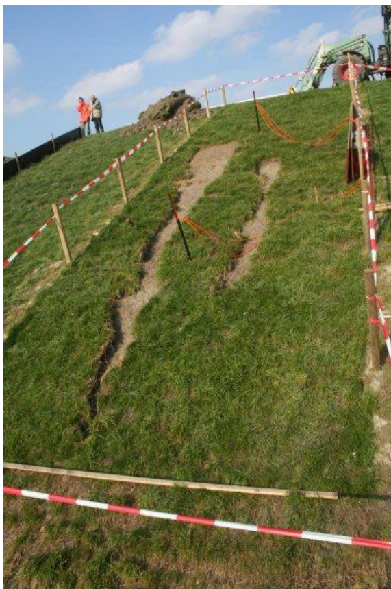
Foto B8. Delfzijl. Grastalud. Afstropen van het gras beneden de initiële schade. Links grastalud, rechts met geotextiel versterkt.
