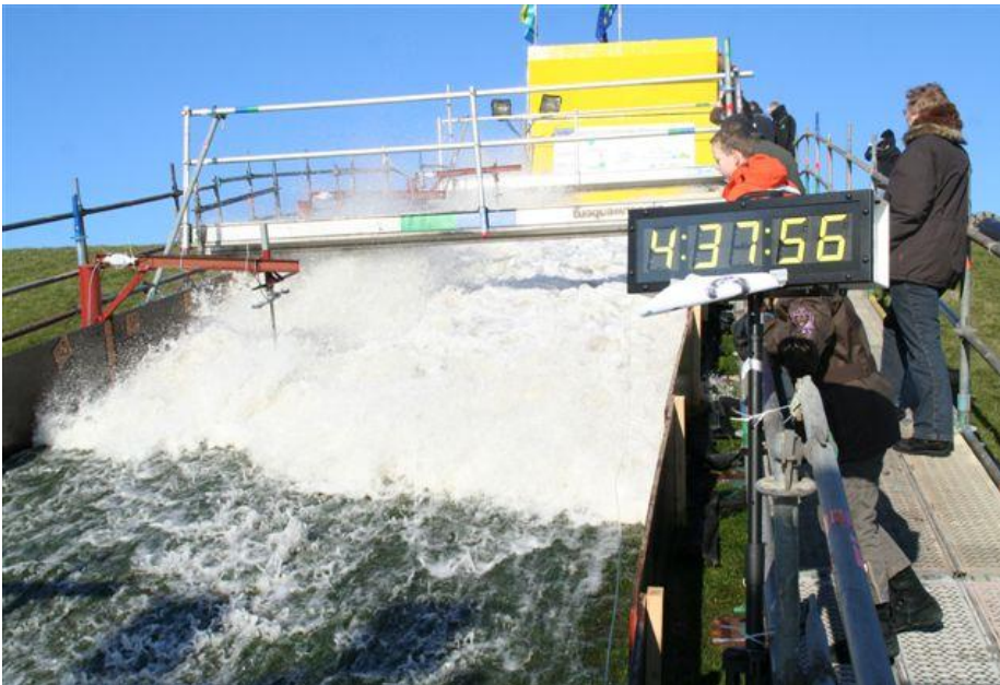
Figuur 4.5 De golfoverslagsimulator die een volume loslaat van 5,5 \text{ m}^3/\text{m} .
