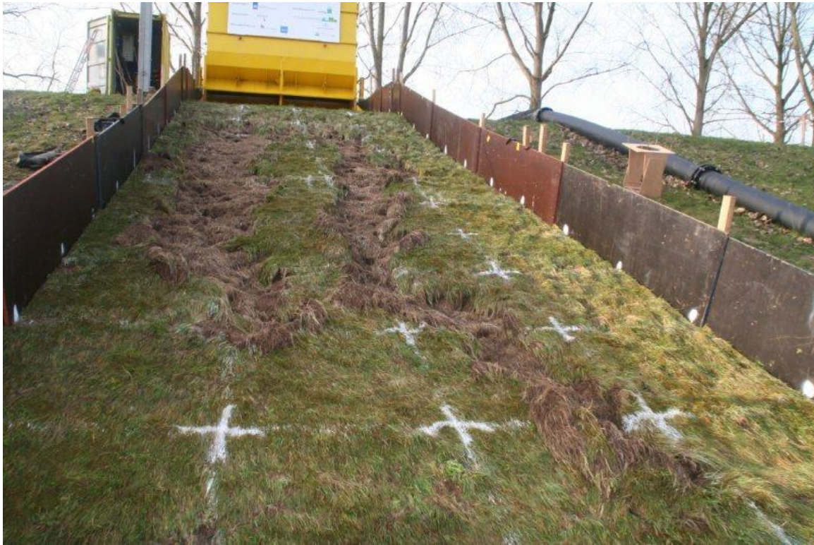
Foto B52. Vechtdijk. Zeer zwaar zeeregime, proef 3; Zand komt vrij door afdeklaag.
