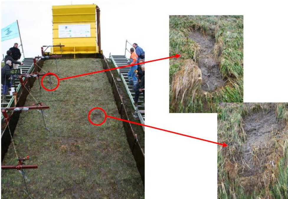
Figuur 5.1 Uittrekmechanisme (golfoverslagproeven op St. Philipsland)
