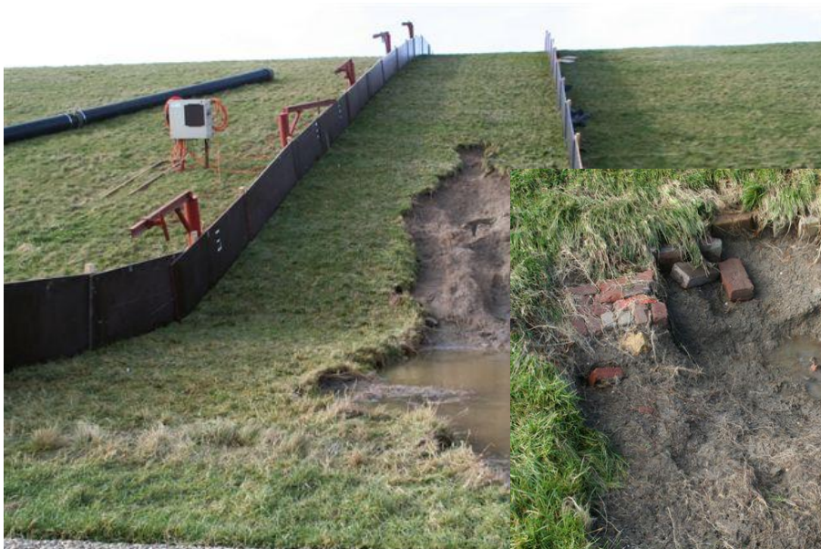
Foto B11. Boonweg. Sectie 3. Na de proef, schade aan het talud en aan de teen.
