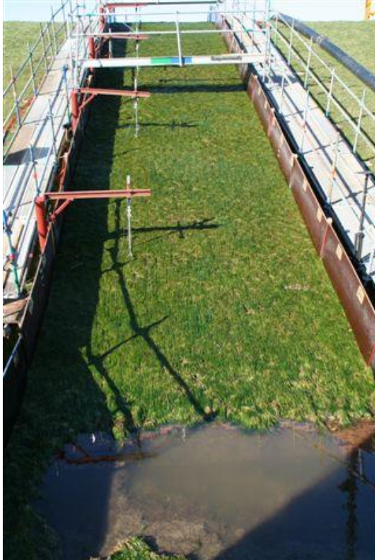
Foto B9. Boonweg. Sectie 1. Na de proef, geen schade aan het talud wel aan de teen
