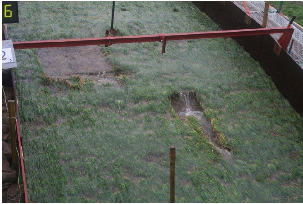
Foto B7 Delfzijl. Grastalud. Initiële schade aangebracht op het talud.
