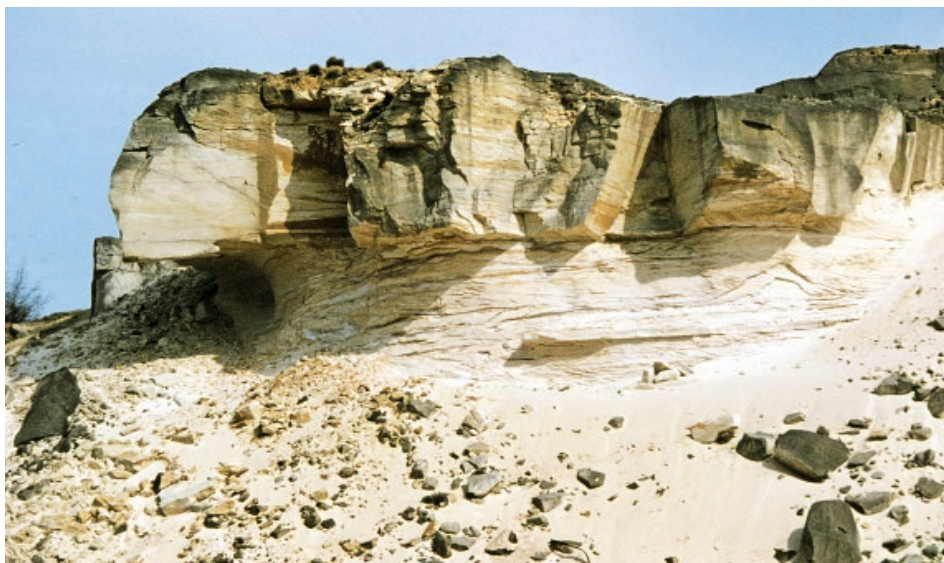
Groevewand in de zandwinning bij Nivelstein. De drie meter dikke zandsteenlaag vormt de ‘caprock’ van het onderliggende zilverzand. | Foto uit 1976, archief TNO-GDN
