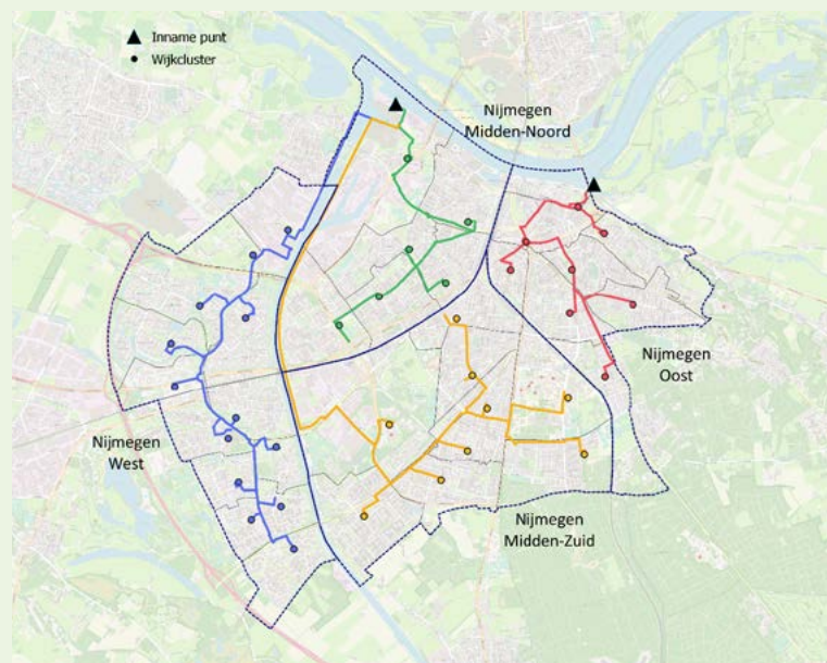
Figuur 3: Mogelijke routes van hoofdtransportleidingen voor warmtenetten in Nijmegen in het geval van aquathermie.
